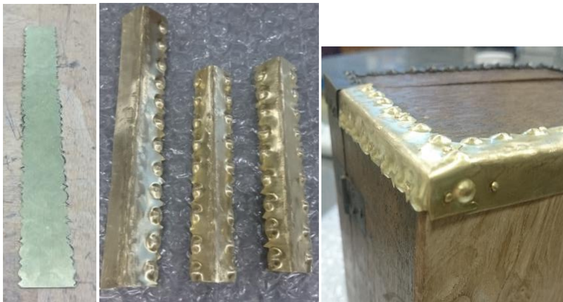
Kuvat 37, 38 ja 39. Helojen valmistusvaiheita: aihio sahauksen jälkeen, helat ennen kiinnittämistä ja takakulma valmiina (Elomaa 2017)
