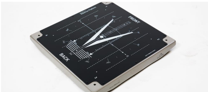
Kuva 1. HUR Labs, FP4 Force Platform- voimalevy (HUR Labs 2017)
