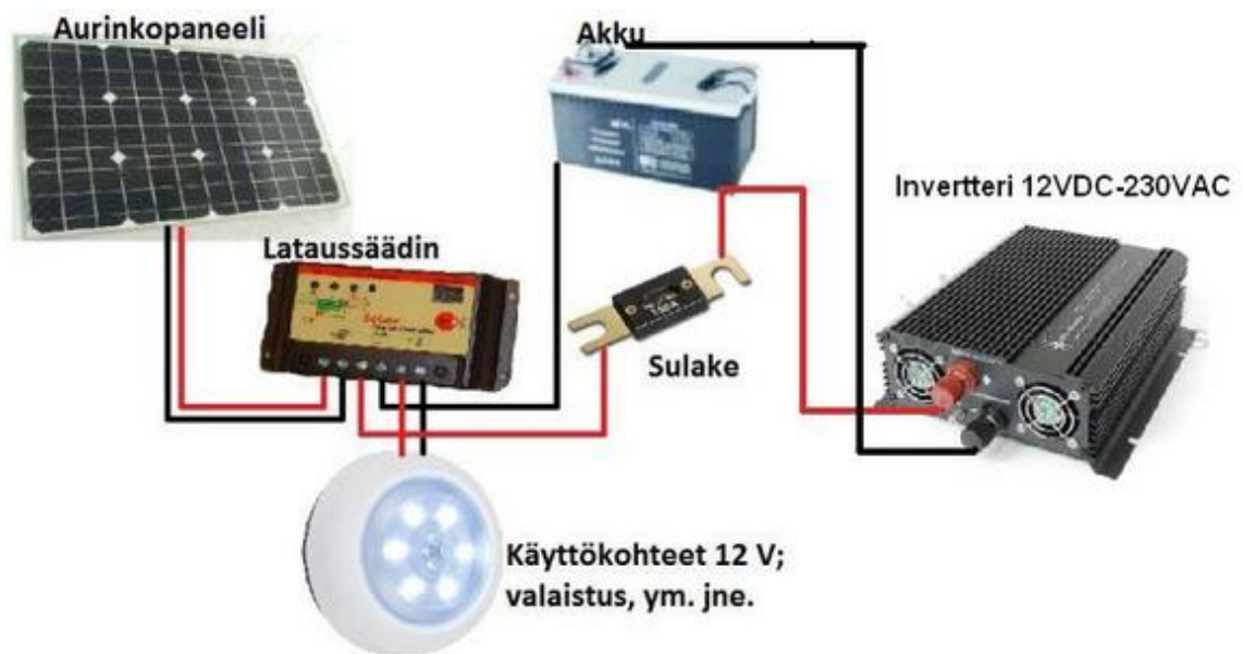
Kuva 17. Vapaa-ajanasunnolle tyypillinen aurinkosähköjärjestelmä (Aurinko.net)
