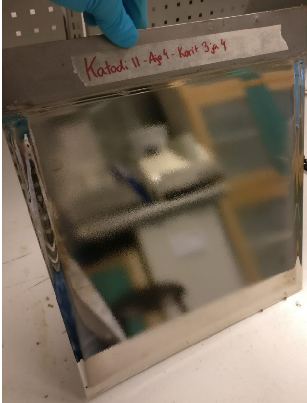
Kuva 6. Kylvyssä vuorokauden kasvanut katodilevy.
