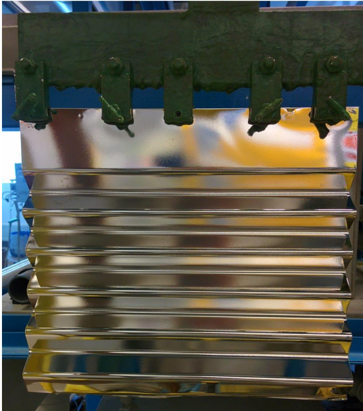
Kuva 7. Poimulevykatodi vuorokauden ajon jälkeen.
