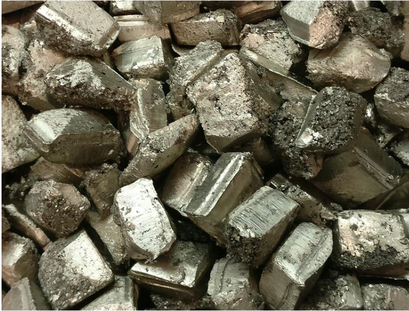
Kuva 14. Anodi 6 paloja kolmannen koeajon jälkeen.
