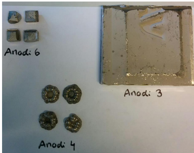
Kuva 4. Toisessa koeajossa testattavat anodit.
