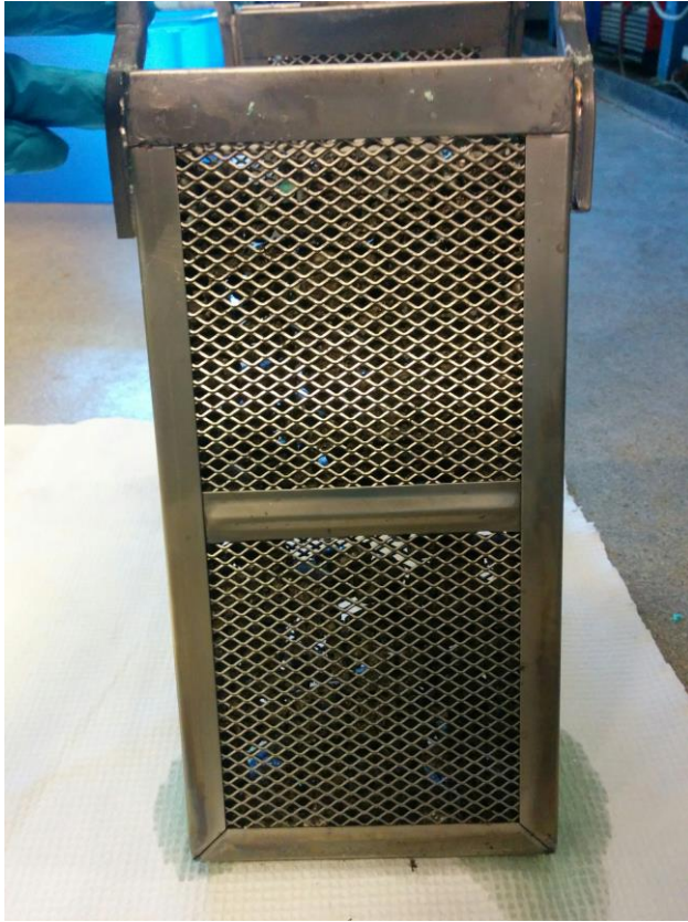
Kuva 11. Anodi 4 ajon 2 jälkeen. Kyseessä on pyöreä, tuuman halkaisijaltaan oleva anodipala.
