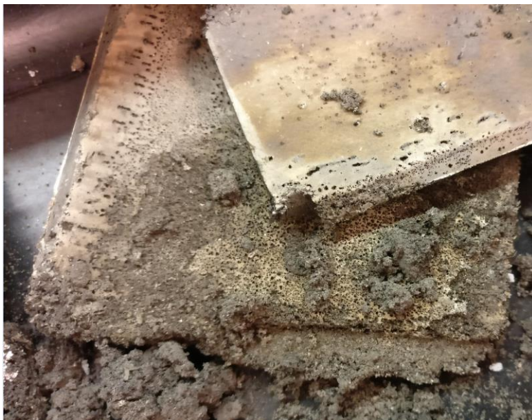
Kuva 15. Anodi 8 paloja neljännen koeajon jälkeen.
