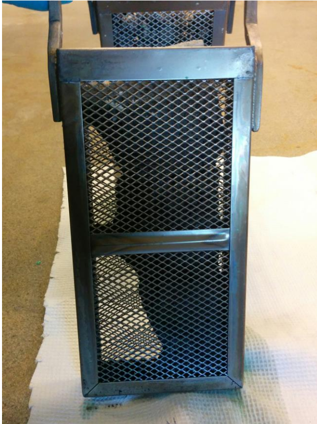
Kuva 10. Anodi 3 ajon 2 jälkeen. Tässä koeajossa ei lisätty uusia anodipaloja kesken ajon.
