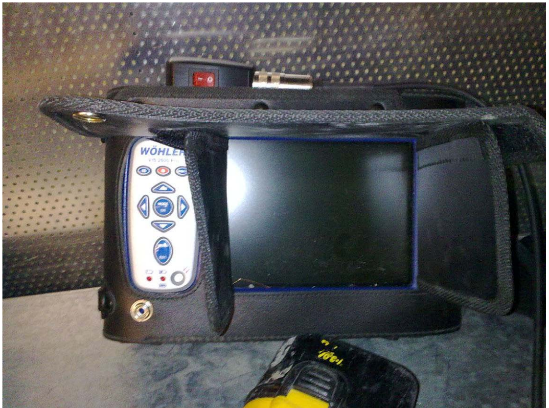
KUVA 5. Wöhler VIS 2000 pro hormikameran näyttölaite. Päivitetty versio SK 95:stä (värikuva ja videomateriaalin tallennus muistikortille). Kuva: Matias Vir-
