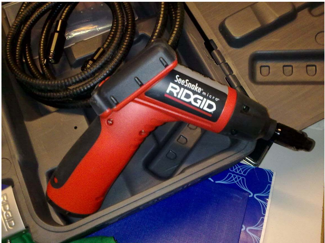
KUVA 3. Ridgid SeeSnake micro videoskooppi ahtaisiin tiloihin. Kuva: Matias
