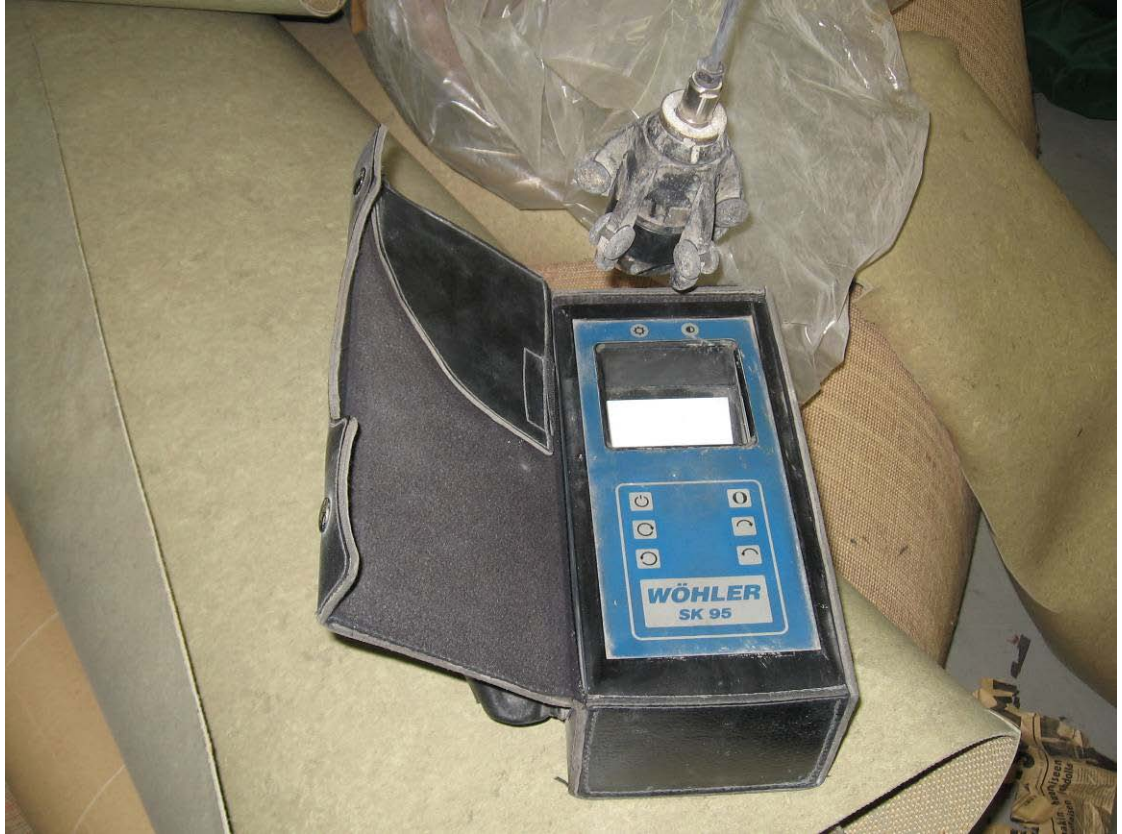
KUVA 4. Wöhler SK 95 hormikamera sekä näyttölaite. Kuva: Matias Virtanen.
