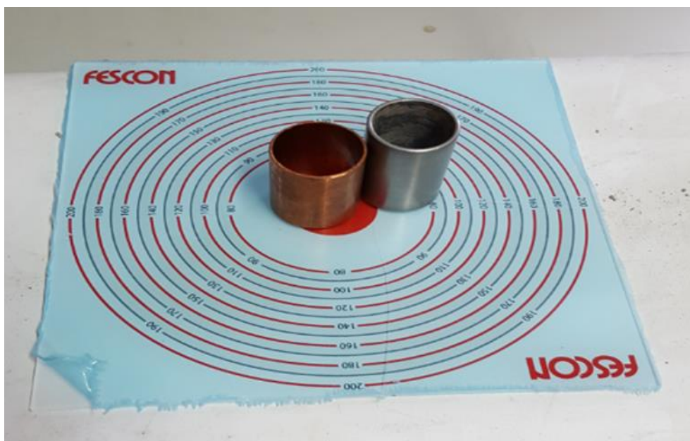
Kuva 8. Fesconin materiaalien leviämän mittaukseen käytettävä kalusto.
