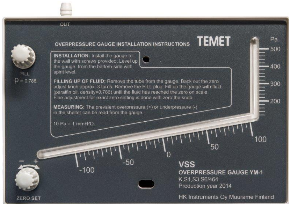
Kuva 6. HK Instruments Oy:n valmistama ylipainemittari YM-3 [9].
