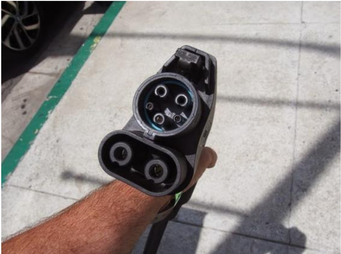
Kuva 8. Tyyppin 1 pistokytin yhdistettynä pikalatausliittimeen (22).
