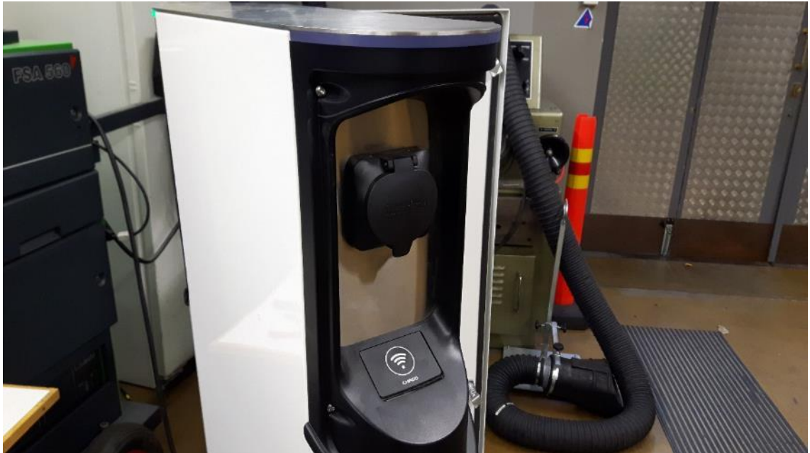
Kuva 19. Sähköajoneuvon latausaseman RFID-lukutaso ja pistorasia.
