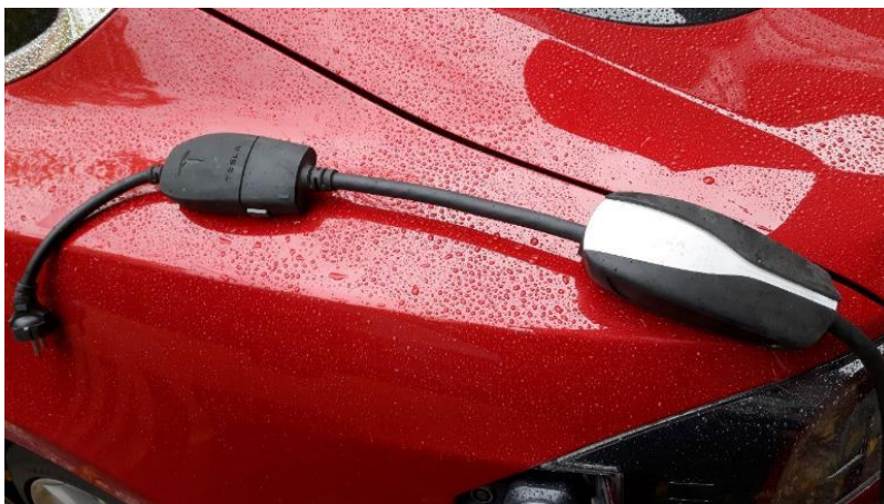
Kuva 5. Tesla Model S -sähköauton lataustavan 2 liitäntäjohdon ohjaus- ja suojalaiteyksikkö.
