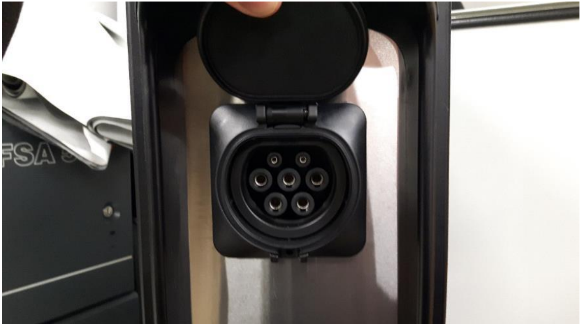
Kuva 18. Tyypin 2 pistorasia latausasemassa.
