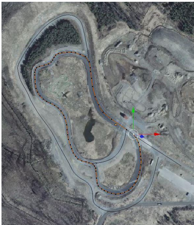
Kuva 13. Heinjoen pääradalle tehty 900m pitkä vaakageometria (Manninen 2017-09-23.)
