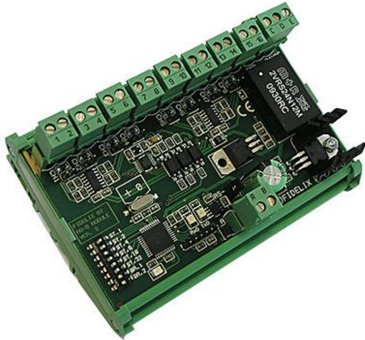
KUVA 4. AO-8 8-kanavainen analoginen säätömoduuli (8)
