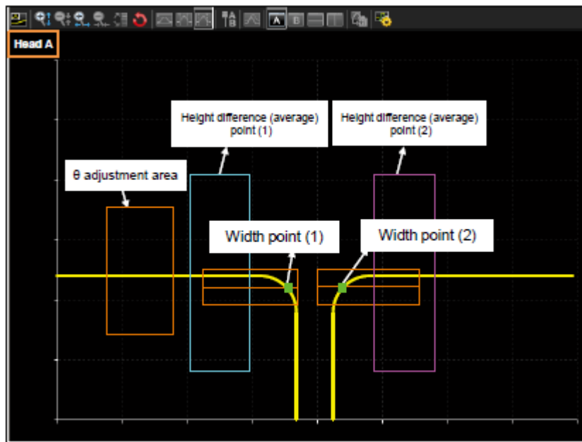
KUVIO 26. Auton koriin tehty mittaus (Keyence: LJ-V7000 Series proposal by Application, 4)
