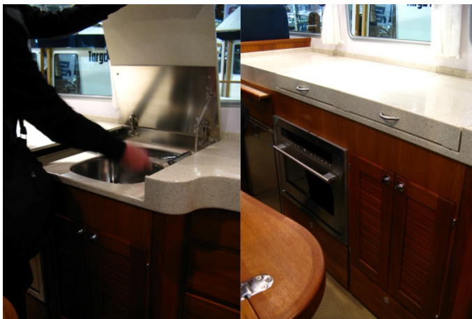
Kuva 10. Avattavat luukut maksimoivat työtilan määrän pentterissä.
