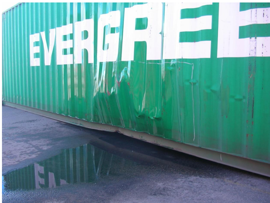
(Kuva 3. Kontin seinä taipunut ulospäin.)
