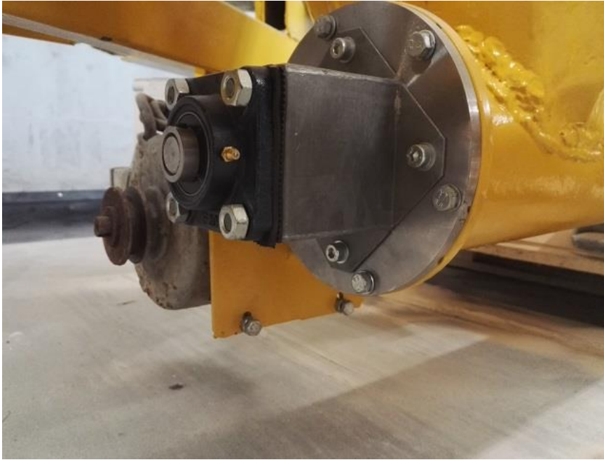
KUVA 12 Spiraalin alapään laakerointi ja teetetty kiinnityslaippa
