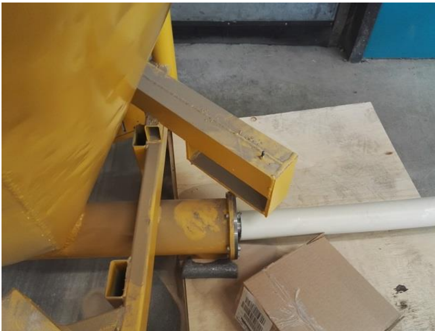
KUVA 13 Spiraalin alapään kiinnitys poistoputken puolelta
