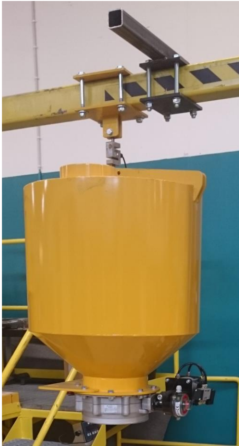
KUVA 11 Moottorin ja punnitusastian kiinnityslaipat
