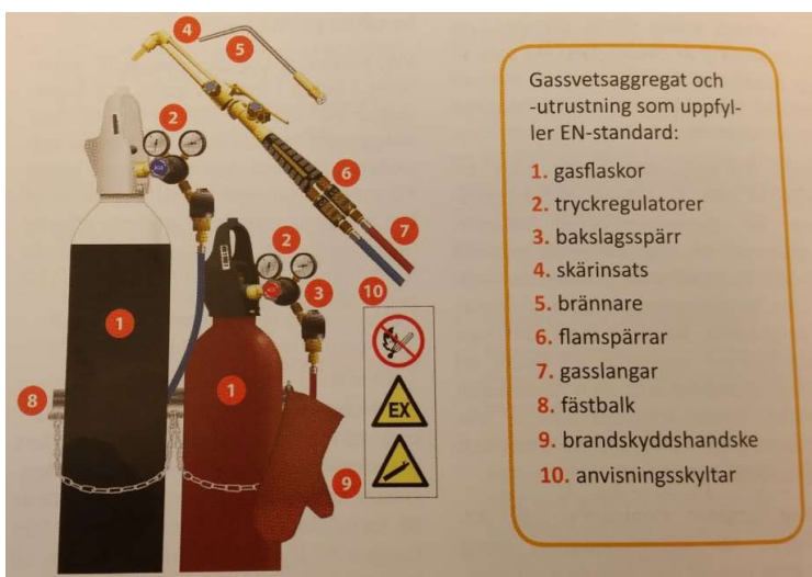
Figur 11. Gassvetsaggregat (Heta Arbeten Lärobok, SPEK)
