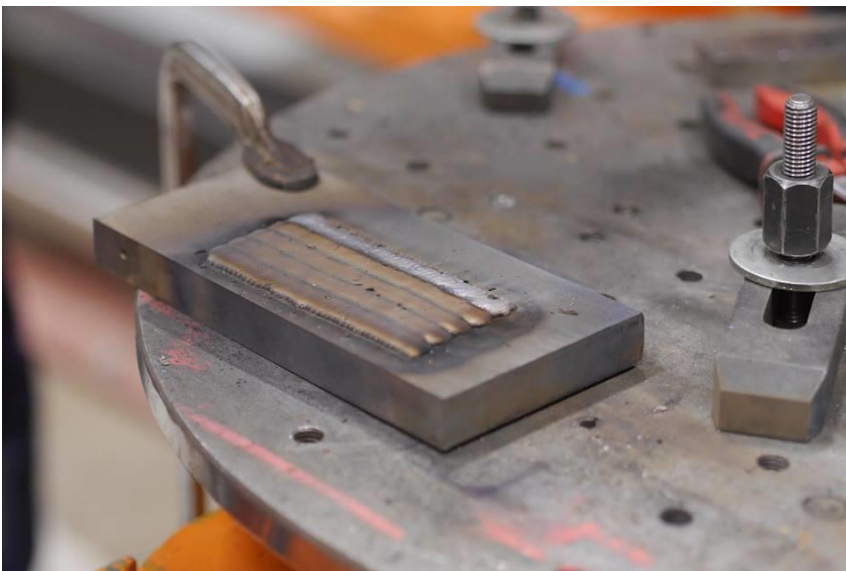
KUVA 3. CMT-hitsausmenetelmällä hitsattu kappale
