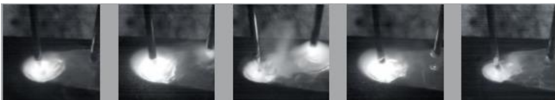
KUVA 6. CMT twin eli kaksoishitsausprosessi ( Pronius 2012, 1)
