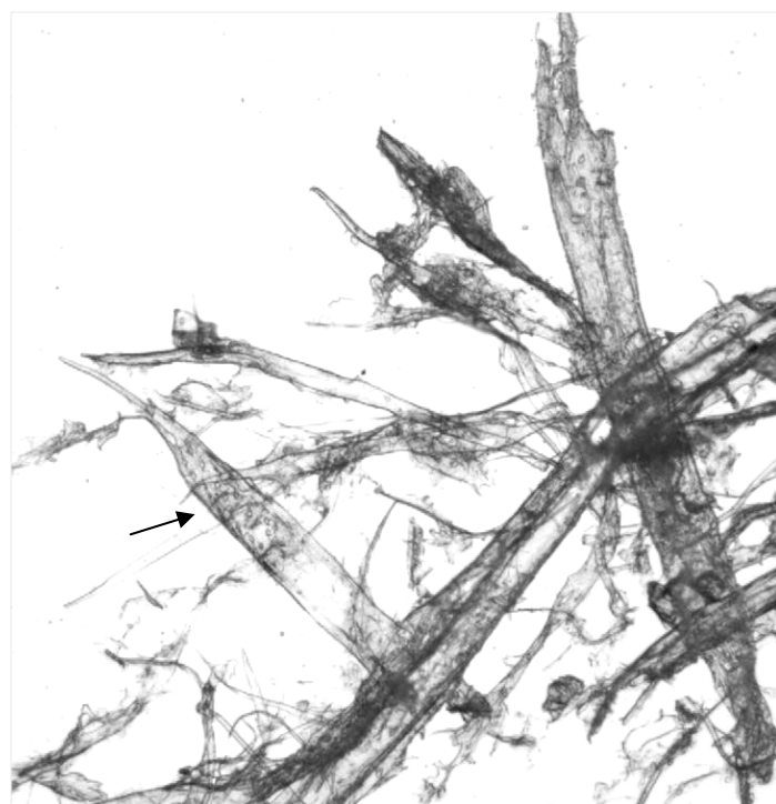
Kuvassa tapettinäytteen 1 (jugend-tapetti) kuituja. Nuolen osoittamassa kohdassa näkyy lehtipuun (nuoli), todennäköisesti haavan putkilosolu. Puumassa voi siis olla niin sanottua ruskeaa hioketta.
