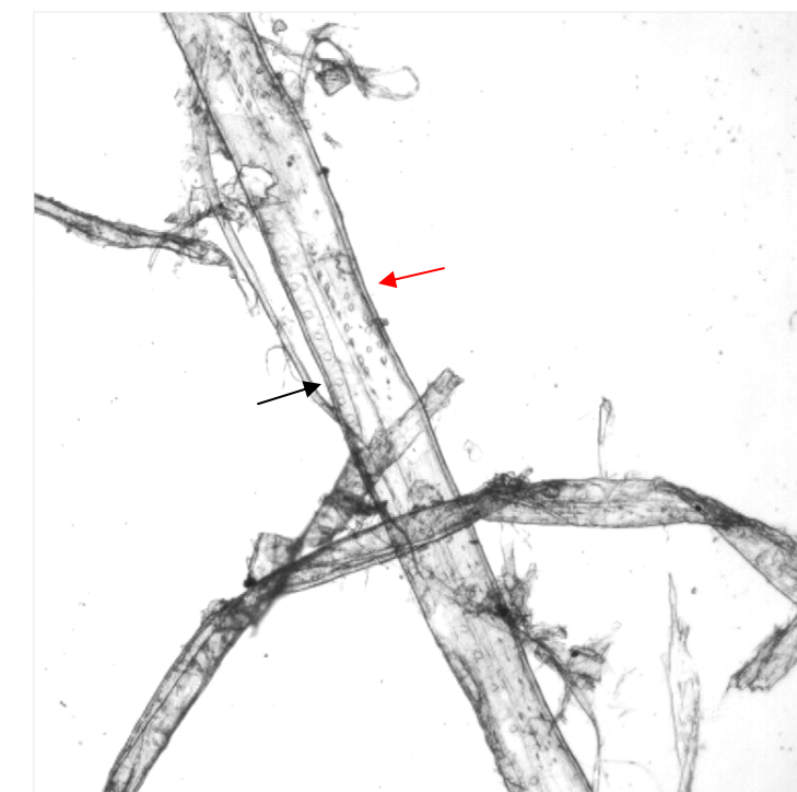
Tapettinäytteestä 4 löytnyt kuusen kuitu. Kuusen kuidun tunnistaa putkilosoluista eli trakeideista (musta nuoli) ja pienistä pistemäisistä ristientän rengashuokosista (punainen nuoli)
