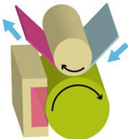
Kuvio 11. Kuviossa on toimintaperiaate direct reversestä, jossa on suljettu kaaverointiyksikkö. (Fuji Kikai Koyo co., LTD. 2017)
