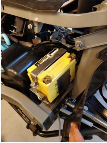
Kuva 4. eStop järjestelmän akku kiinnitettyä ajoneuvoon.
