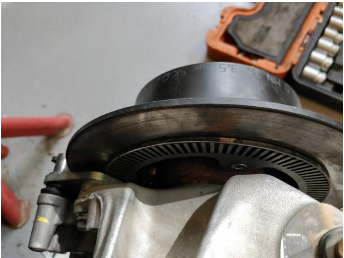
Kuva 10. Etupään nopeusmittauslevy asennettuna.
