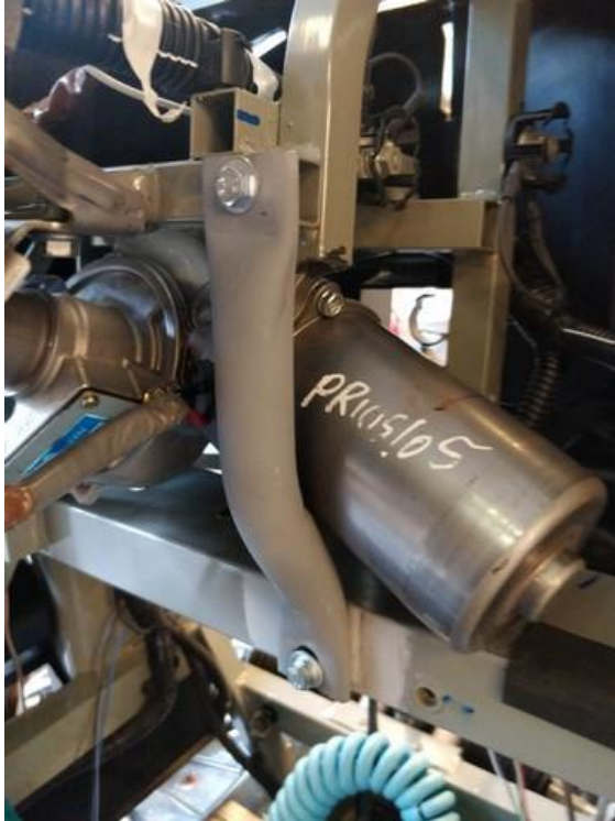
Kuva 5. Ohjausakselin toimilaite asennettuna ajoneuvoon.
