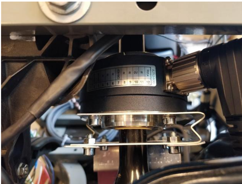
Kuva 9. Asteittain lukeva anturi kiinnitettynä ohjausakseliin.
