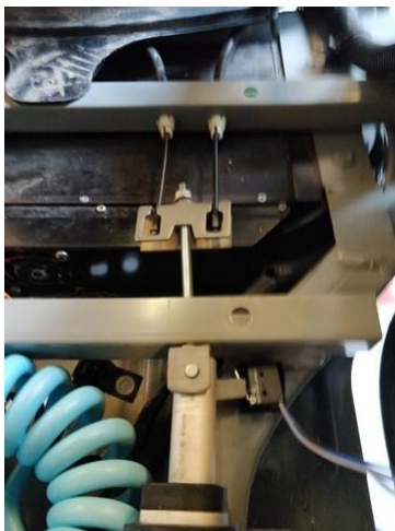
Kuva 7. Käsijarrun toimilaitteen kiinnitys käsijarruvaijereihin.
