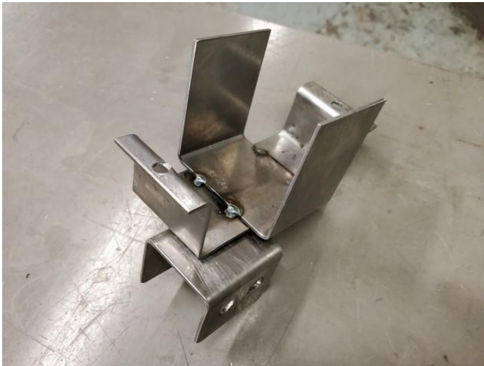
Kuva 9. eStop-järjestelmän akun kannake.
