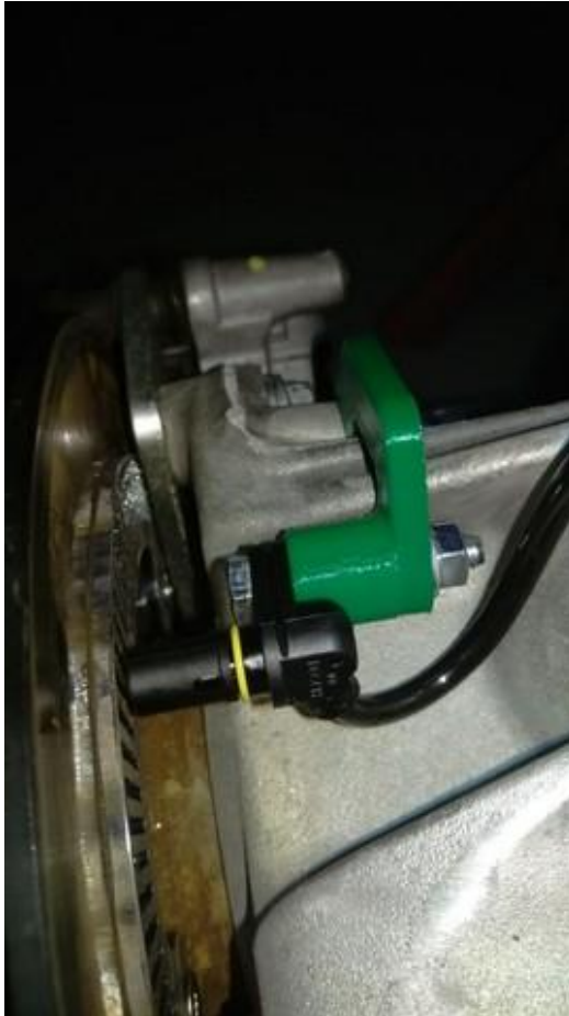
Kuva 13. Etupään nopeusanturi asennettuna.
