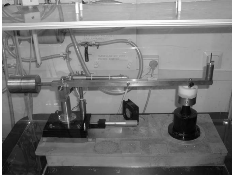
Kuva 17. Itä-Suomen yliopiston tappikulutuslaite (Pin On Disk). Sijainti Kuopion kampusalueen Panos-rakennuksessa.
