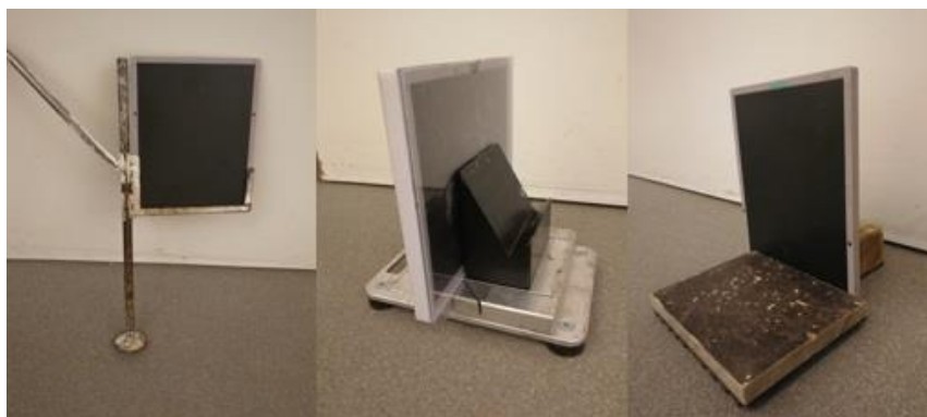
KUVA 2. Erilaisia versioita kuvauksessa käytettävistä apuvälineistä. Ensimmäisenä varrellinen kasetinpidike kintereen tai etupolven kuvaukseen, toisena kasettiteline kavion kuvaukseen ja kolmantena koroke, jonka päälle hevosen jalka asetetaan raajan distaalisten osien kuvauksessa, kuvakasetti voidaan tukea koroketta vasten. (Tolonen 2017)
