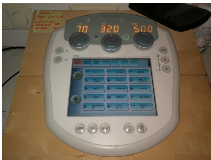
KUVA 1. Erään valmistajan säätöpöytä. Säätöpöydän yläpaneelissa nähdään käytettävä jännite (70 kV), virta (320 mA) ja säteilytisaika (500 msec). Alavalikoista valitaan sopiva kuvausohjelma. (Tolonen 2017)
