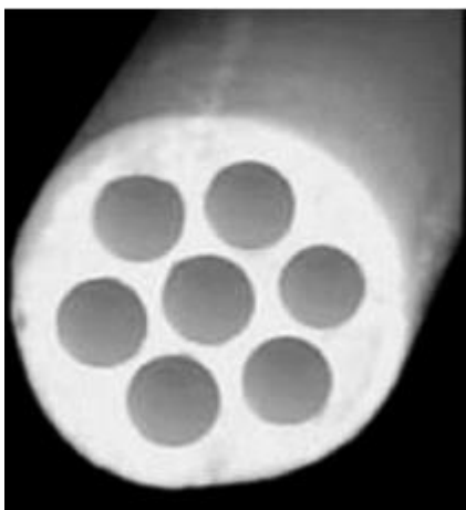
PICTURE 4. The structure of a hollow fiber membrane (Kainua & Hentilä. 2011, 18.)
