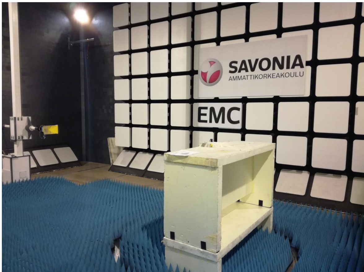
Kuva 1. Savonia EMC-laboratorio Semi Anechoic Chamber
