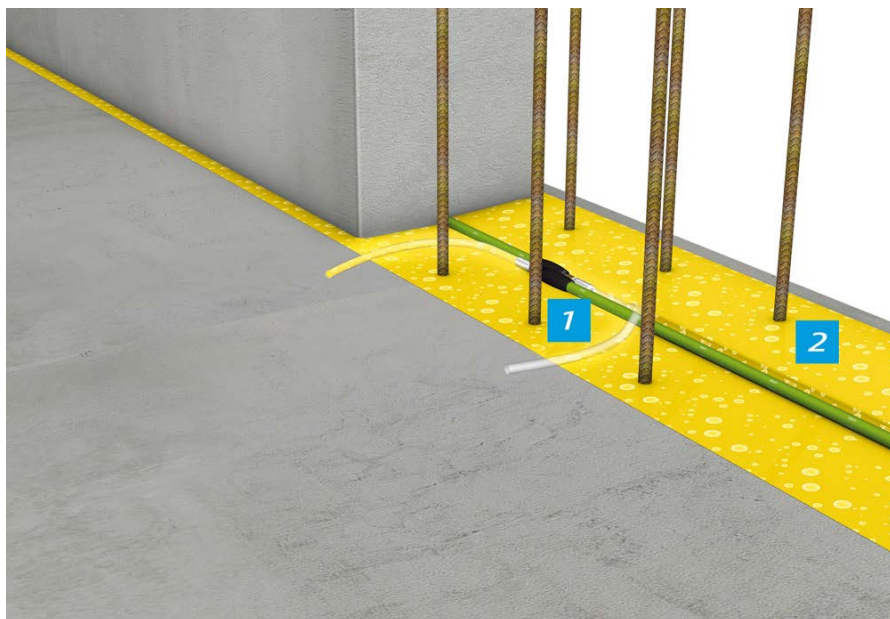
KUVA 5. Injektointiletkujen limitys (koester-bauchemie.com, 2017)
