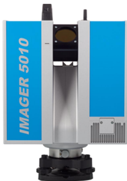
Kuva 11. Koemittauksesta käytetty laserkeilain Z + F imager 5010 [20].
