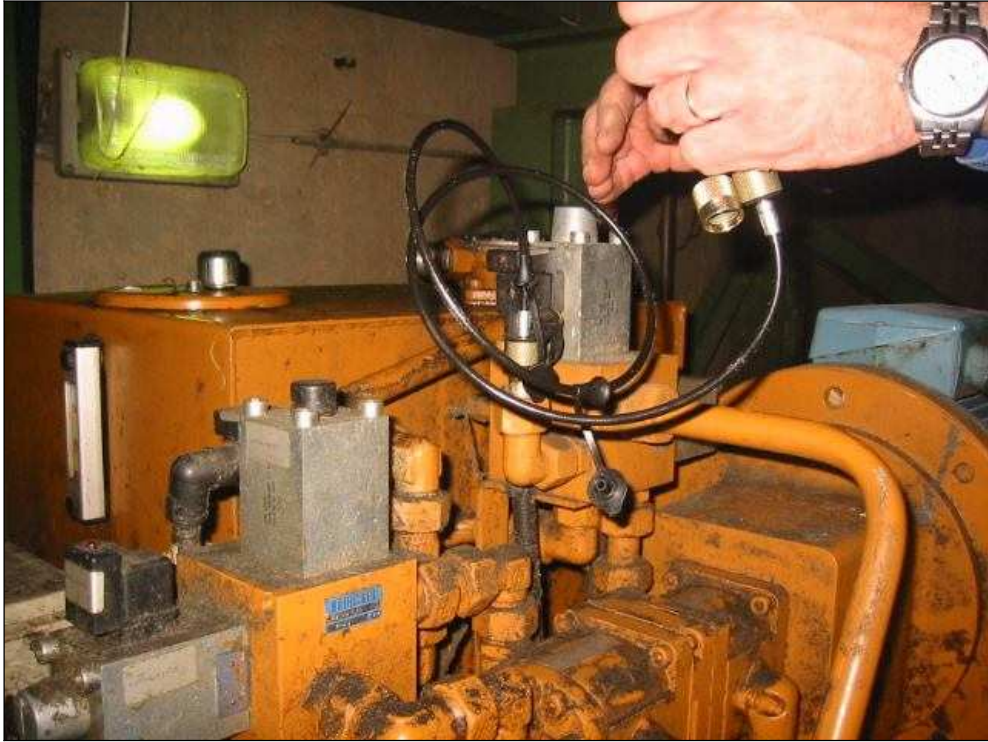
Kuva 12. Painemittarin liittäminen koneikkoon
