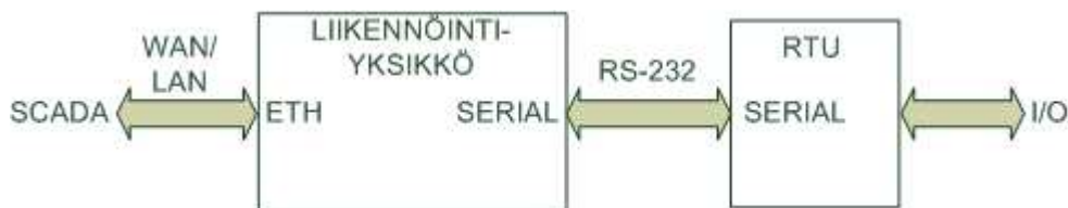
Kuva 10. Sarjaportin avulla liikennöintiyksikköön liitetty RTU.
