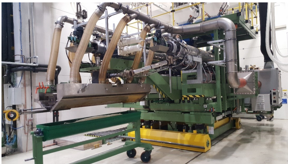
Kuva 11. Ekstruuderin kokoonpano ja eri osat.
