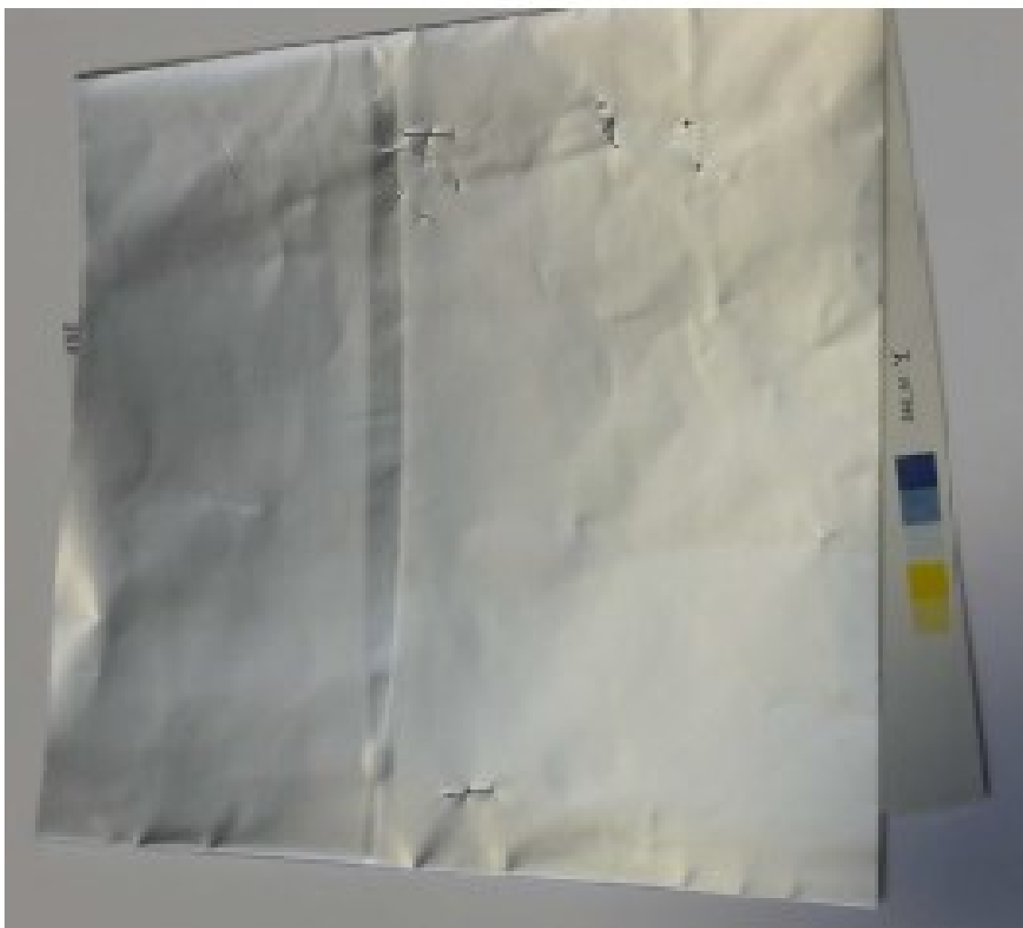
Kuva 1. Muovifilmin halkeama eristetuotteessa
