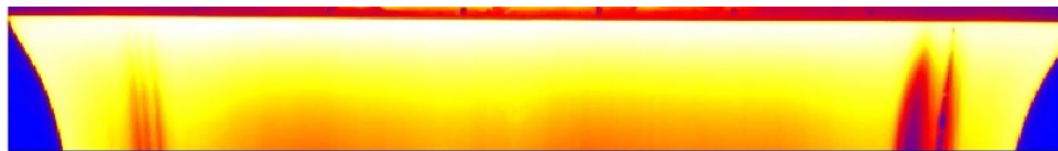
Kuva 46. Sula muovifilmi RGB-värein kuvattuna FLIR A35 konenäkökameralla.
