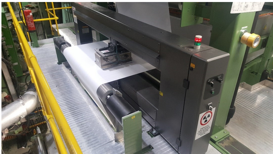
Kuva 29. Mittausyksikkö mittaa yhden pisteen kerrallaan ja kohdistaa saadun arvon säätöpulttikohtaisesti materiaaliradan leveys suunnassa.
