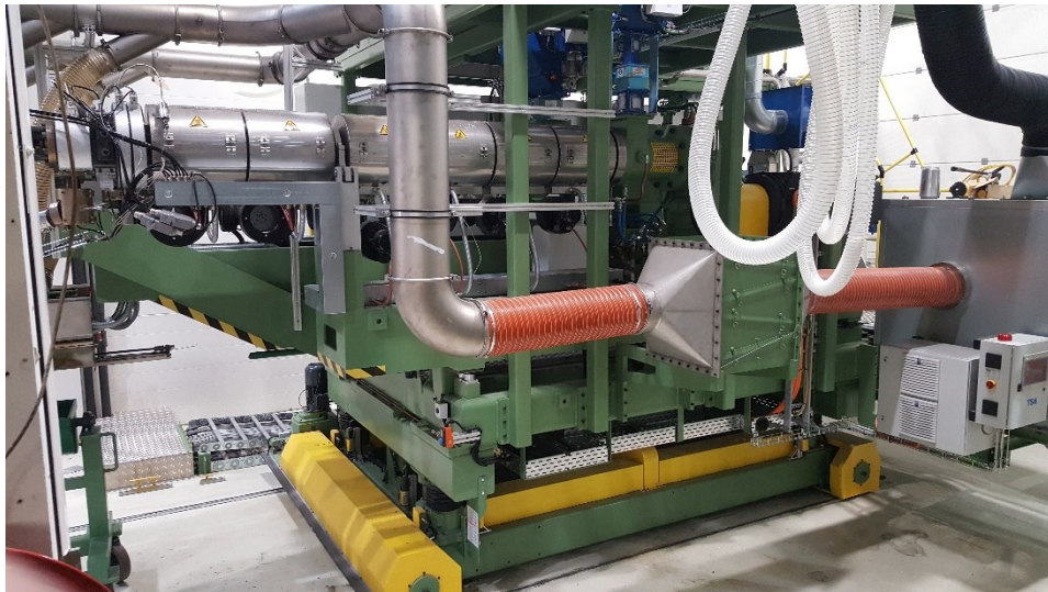
Kuva 24. Siirtovaunu johon asennettuina ekstruuderin eri osat.
