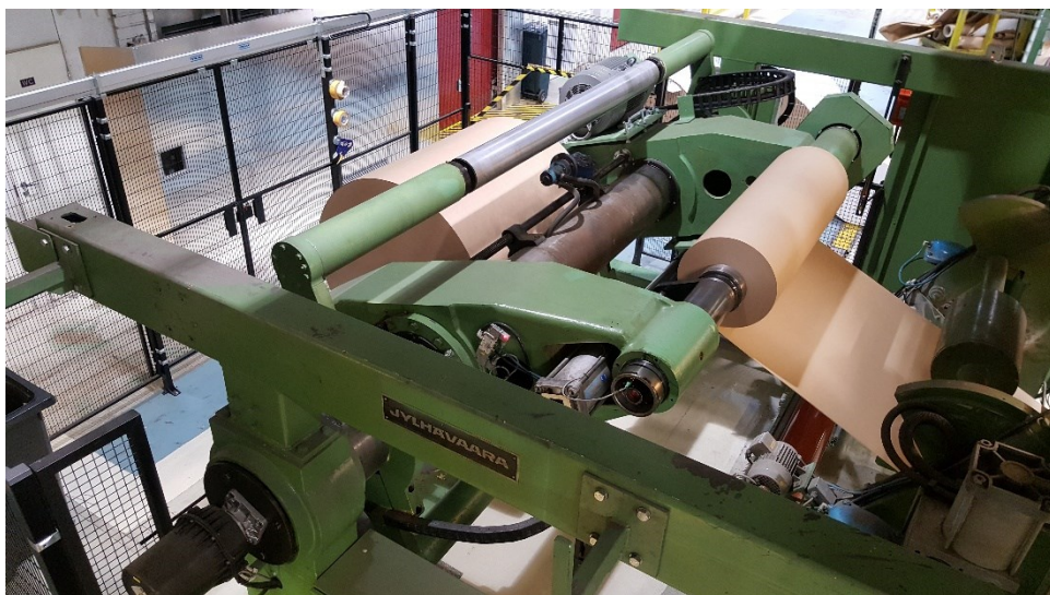
Kuva 5. Aukirullaimen kokoonpano ja osat.
