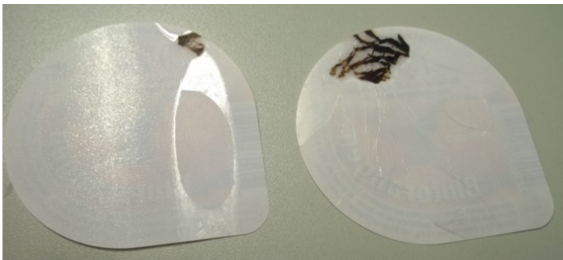
Kuva 2. Muovifilmin halkeama ja epäpuhtauksia elintarviketuotteessa
