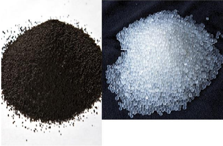
Kuva 14. Tyypillisiä adsorbenttejä ovat aktiivihiili ja silikageeli. [11; 12.]
