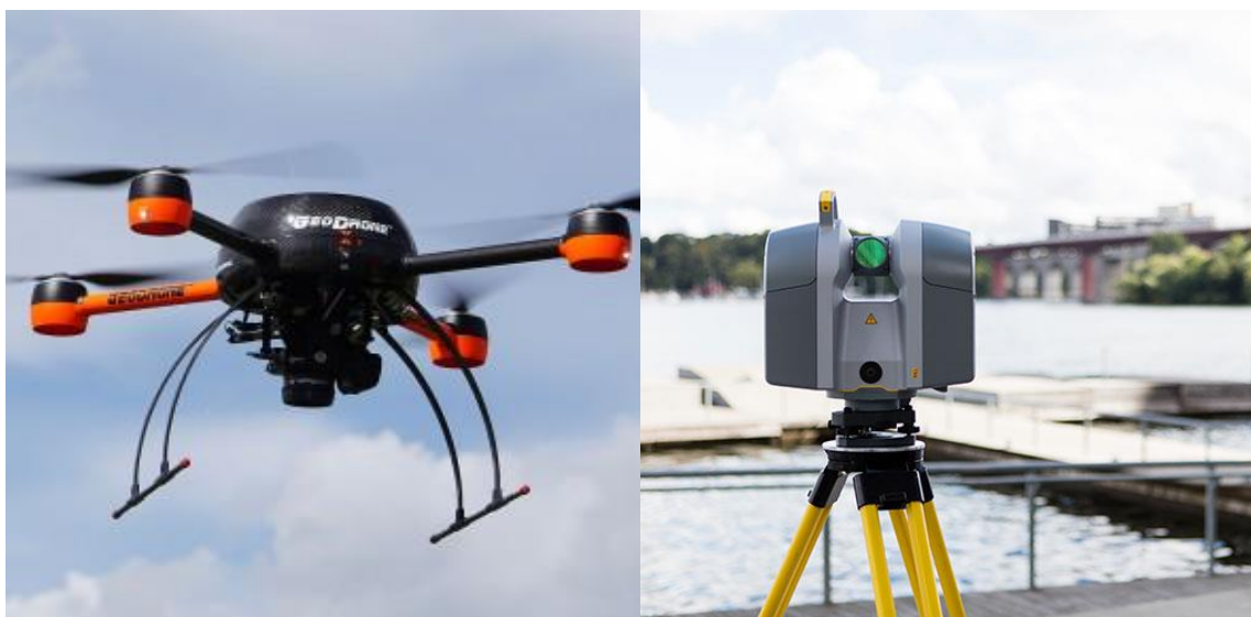
KUVA 11. GeoDrone X4L ilmalaserkeilain ja Tribble TX6 maalaserkeilain (17)
