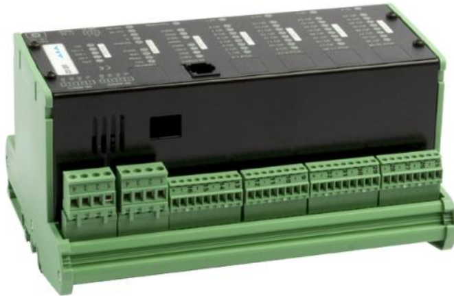
Kuvio 2. UIO-32-universaalisäädin (UIO 032 univesaalisäädin tuote-esite, 2006,)
