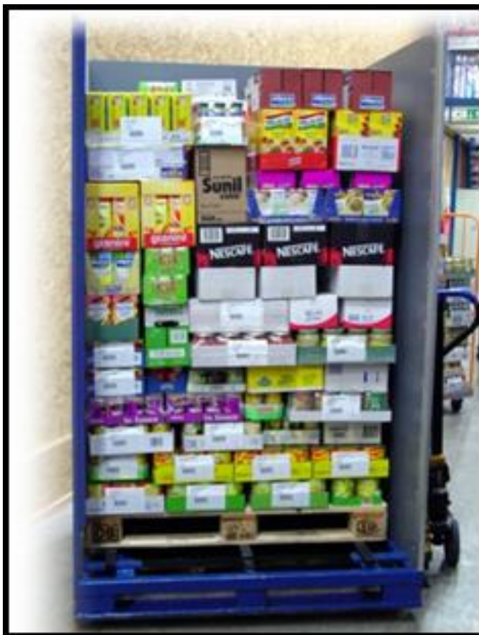
Kuvio 11. Esimerkki COM-keräyksen lavasta, jonka ympärillä on turvakehys
