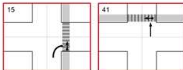
Kuva 54. Onnettomuustyyppi 15, ”Pyöräilijä pyörätiellä, toinen kääntyi oikealle”, sekoitettiin usein tilanteeseen, jossa autoilija oli kääntymässä oikealle vasta pyörätien jatkeen jälkeen.
