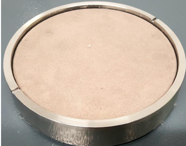
Kuva 20. Hienokeraaminen kaasuhajotin ennen käyttöönottoa (halkaisija 185 mm)
