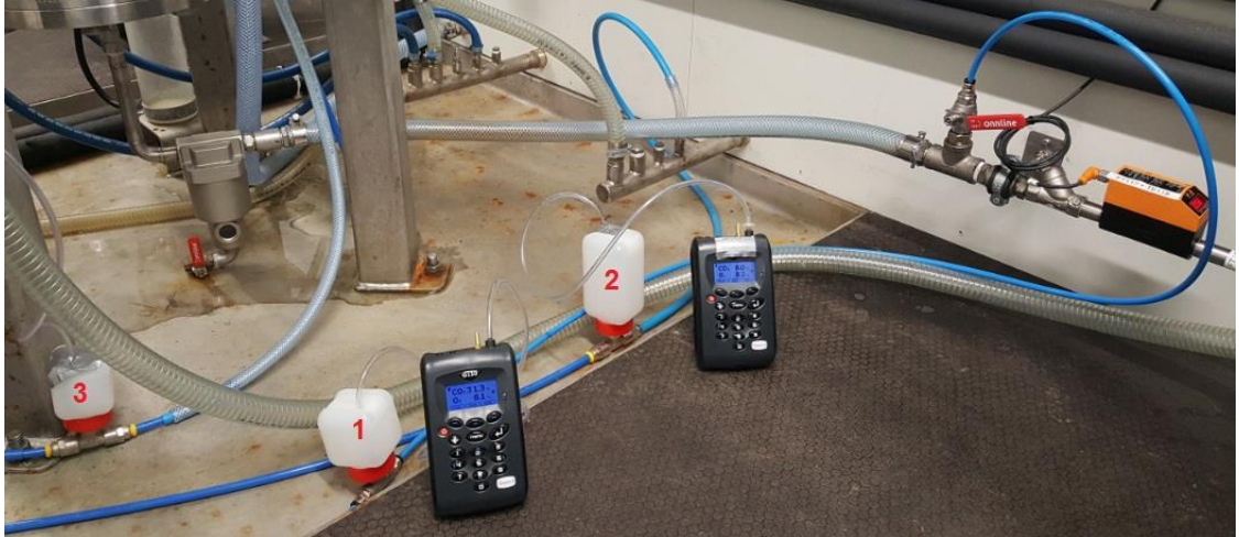
Kuva 17. Kaasulinjojen mittauskohdat ja Geotech G110 -kaasuanalysointilaitteet
