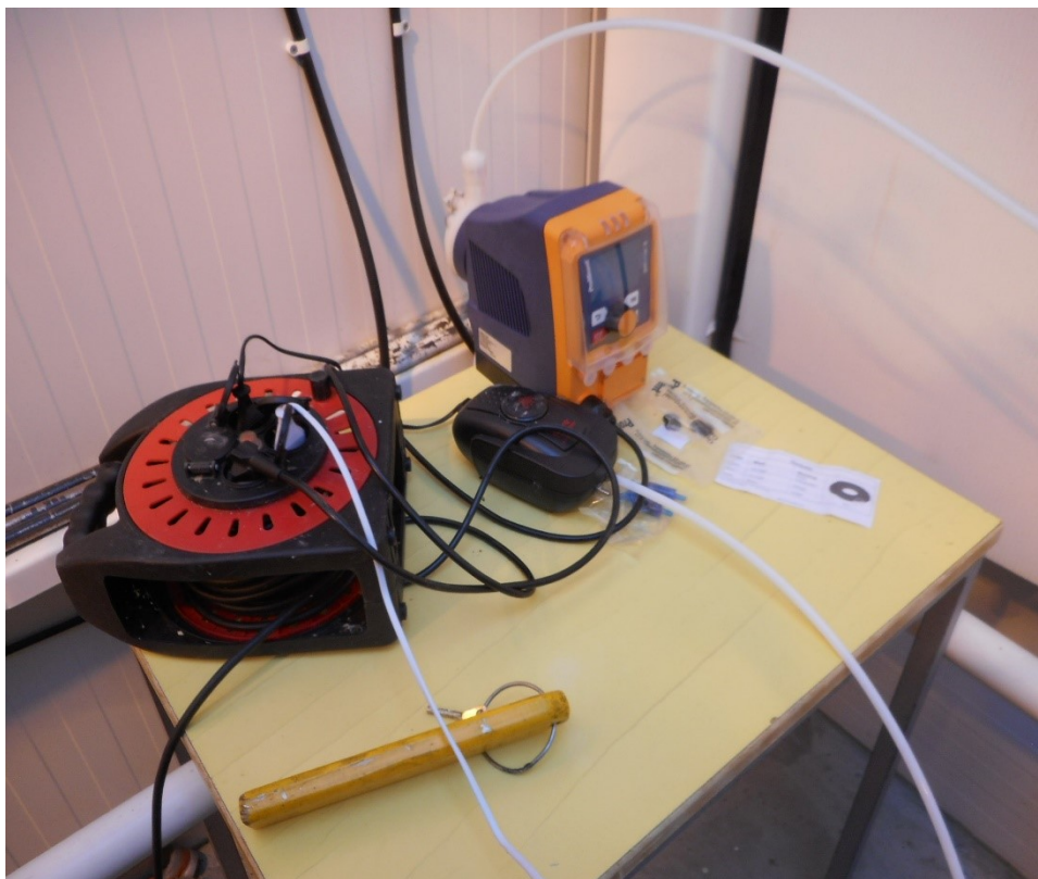
Kuva 3. Ilmapumppu ja annostelupumppu.
