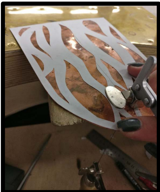
Kuva 10 Epoletin prototyypin sahaus (Kontunen 2017).
