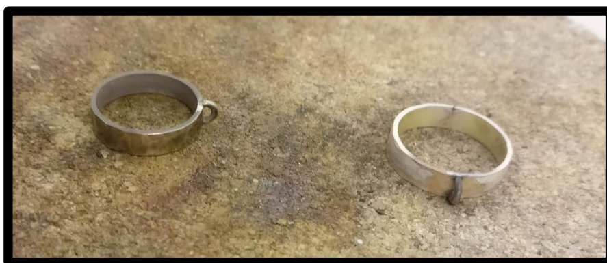
Kuva 19 Lenkkien juottaminen sormuksiin (Kontunen 2017).
