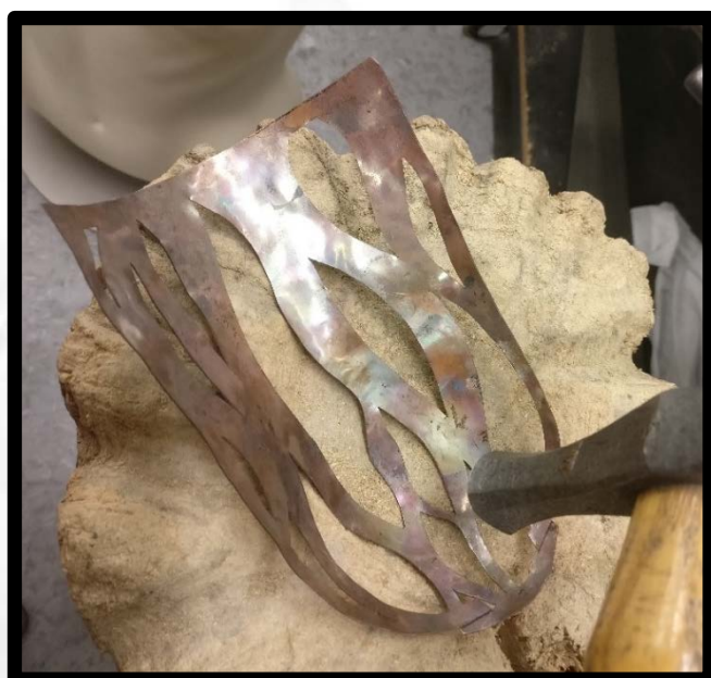
Kuva 9 Epoletin prototyypin taonta (Kontunen 2017).
