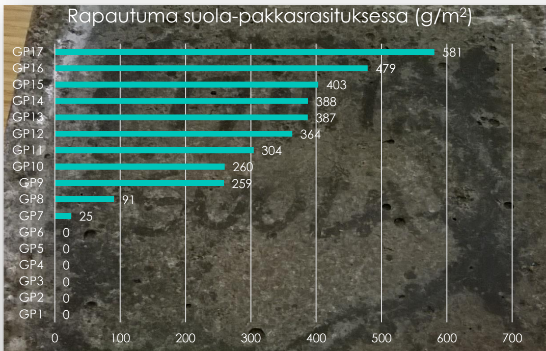
KUVA 8. GEOPOLYMEERIKOEKAPPALEIDEN RAPAUTUMA SUOLA-PAKKASRASITUKSESSA.
