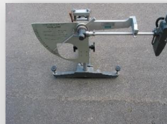
KUVA 5. VASEMMALLA KAHDEN GP-MATERIAALIN LIUKKAUSVASTUSTEN KESKIARVO. OIKEALLA KUVA LIUKKAUSVASTUKSEN TUTKIMISESSA KÄYTETYSTÄ LAITTEESTA.
