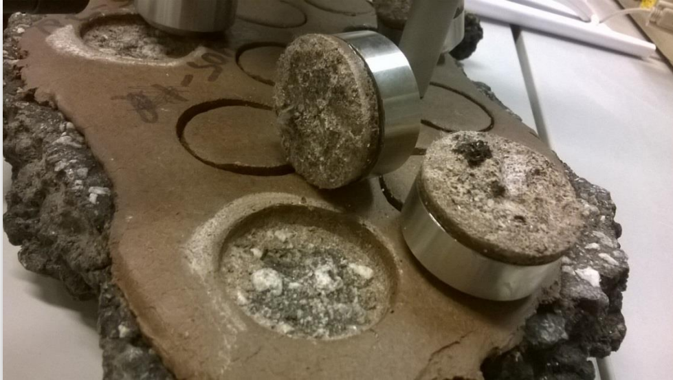
KUVA 7. GEOPOLYMEERIPAikkAMASSAN TARTUNTA VANHAAN ASFALTTIIN.
