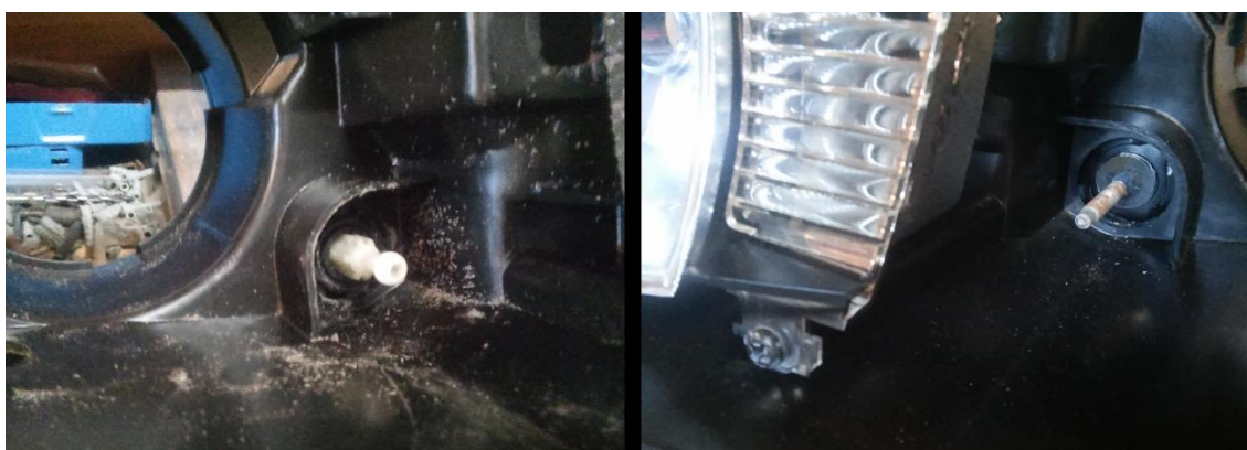
KUVA 16. Säättömoottori asennettu (vasen), alkuperäinen säätöruuvi (oikea)
