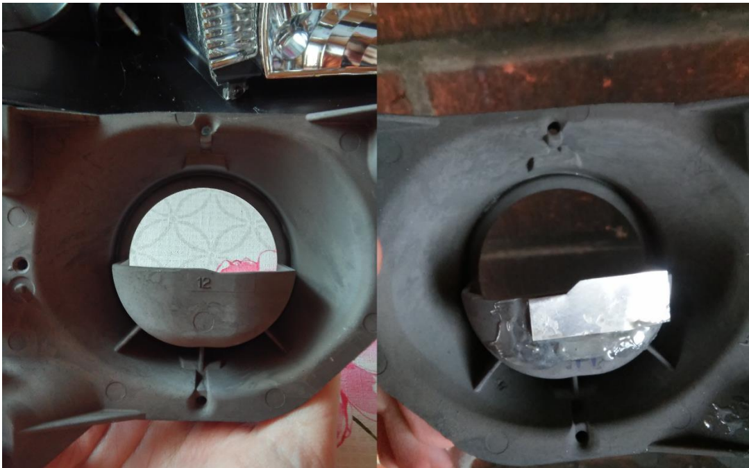
KUVA 13. Varjostin, alkuperäinen ja muokattu
