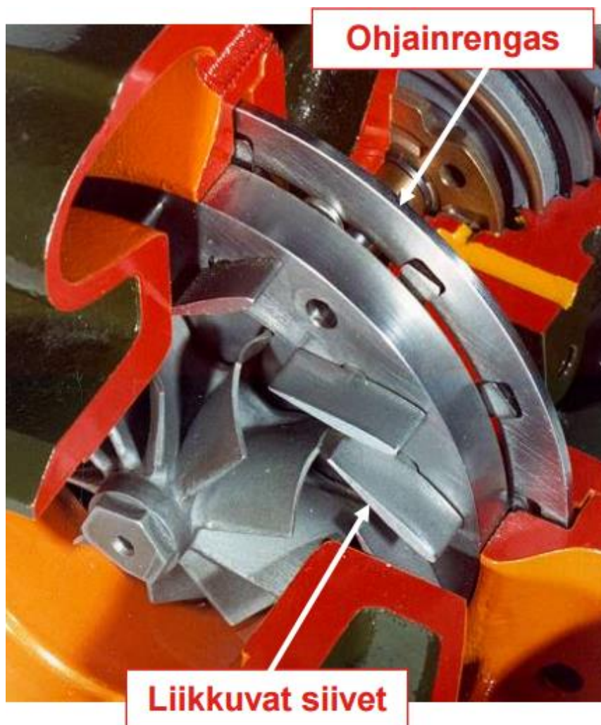
Kuva 3. Muuttuvageometrisen ahtimen läpileikkaus (Turbotekniikka 2017b)
