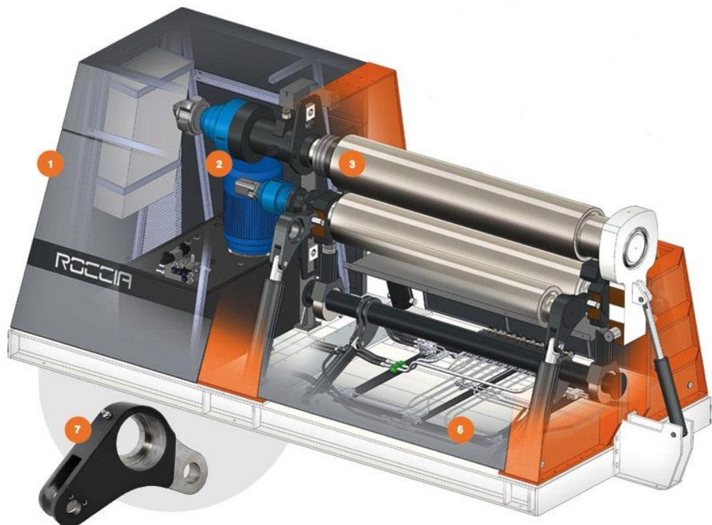
Kuva 31. Planetaaritelallisen pyöristyskoneen rakenne [13]
