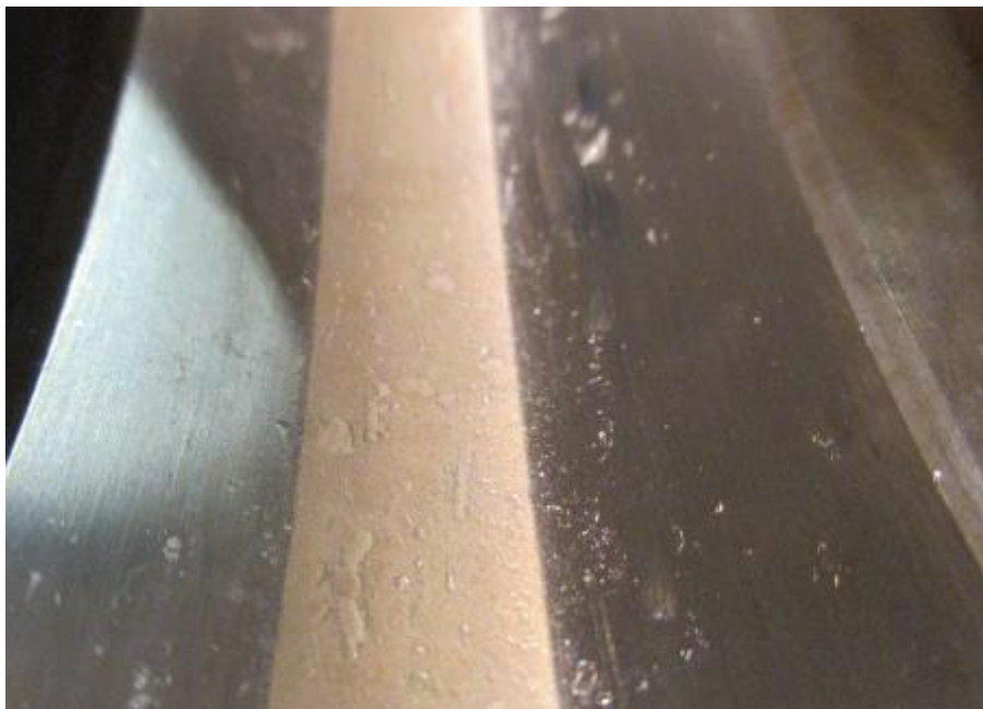
Kuva 31. Sisäkehällä näkyvissä harmaantunut kuormitusalue sekä "monttuja", jotka mikroskoopilla tarkasteltaessa havaitaan sähkönkulun aiheuttamiksi "kraatereiksi".
