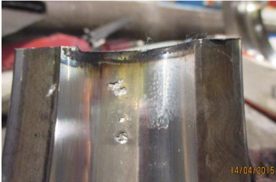
Kuva 34. Ulkokehällä paikoin isoja kuoriutumia.
