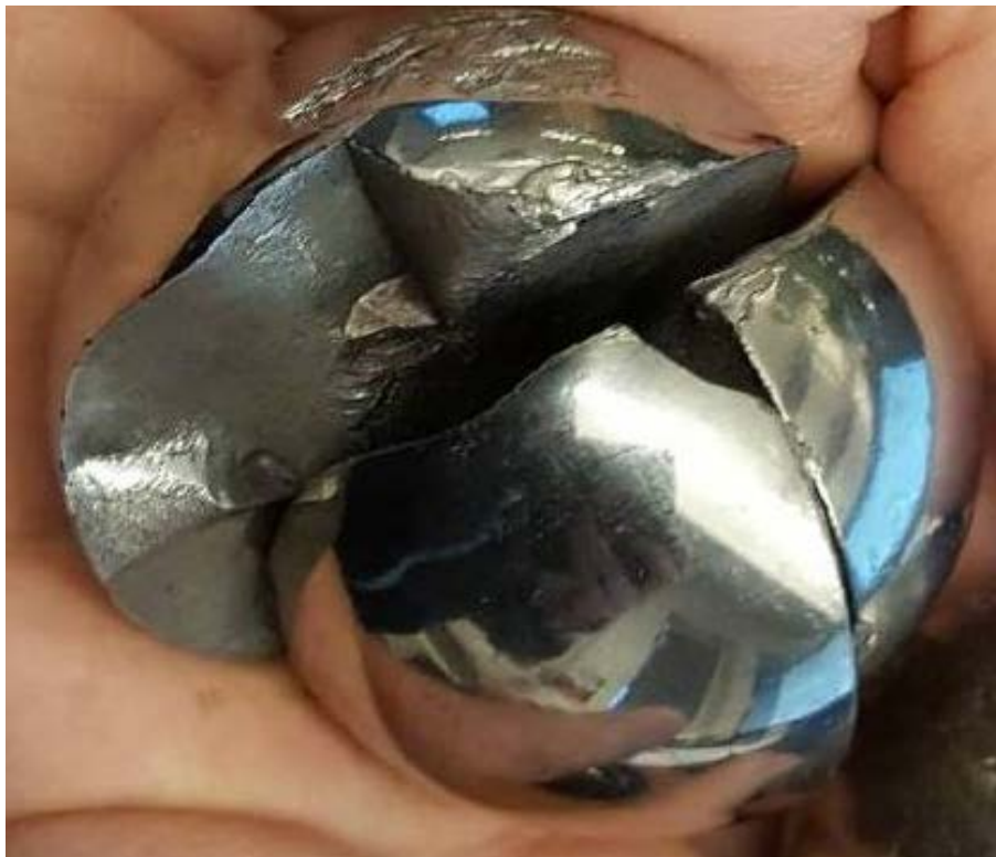
Kuva 33. Kun vaurio etenee liian pitkälle, myös laakerin kuulat antavat periksi ja voivat haljeta. Jos vikaantuminen etenee näin pitkälle, totaalinen tuho myös generaattorille on todennäköistä.
