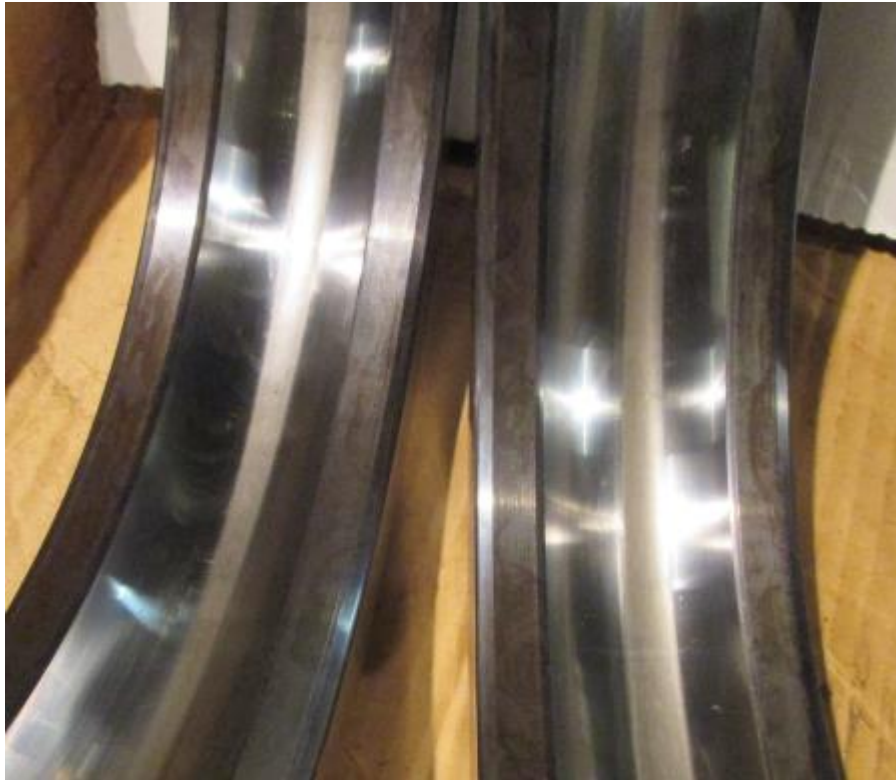
Kuva 30. Laakerin ulkokehällä näkyy varsin voimakasta sähkönkulun aiheuttamaa "kulumaa". Mikroskoopin 1000-kertaisella suurennoksella kuluma voidaan tunnistaa kraaterimaisiksi monttuiksi, jotka ovat tyypillisiä sähkönkulun aiheuttamia vaurioita.
