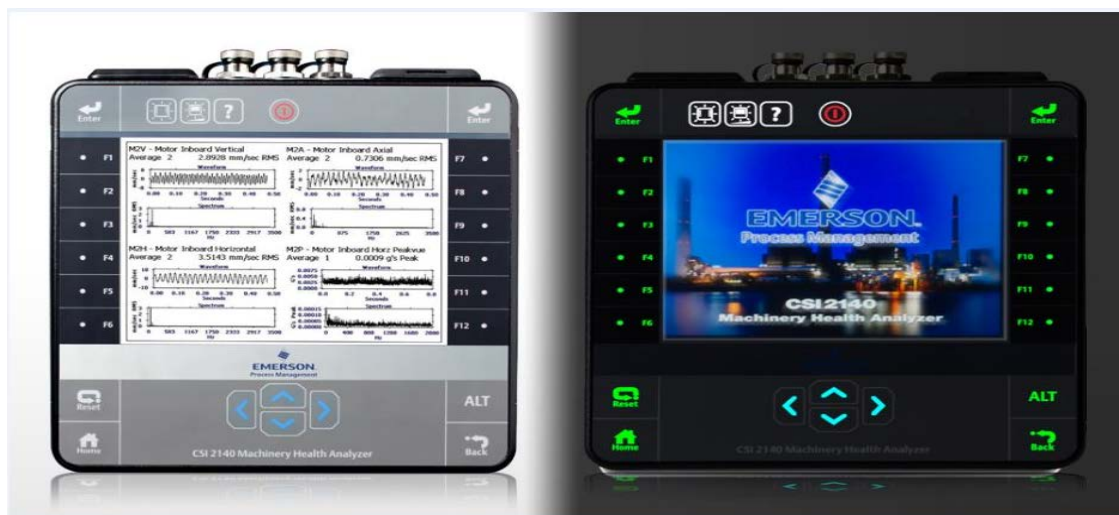
Kuva 12. CSI 2140 analysaattori (Emerson 2015.)
