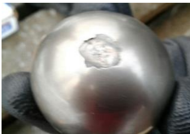
Kuva 19. Laakerinkuula, sähkönkulun aiheuttama vaurio. Laakeri oli eristetty sisäkehältään, ja kesto-ikä laakerilla ~3 vuotta.
