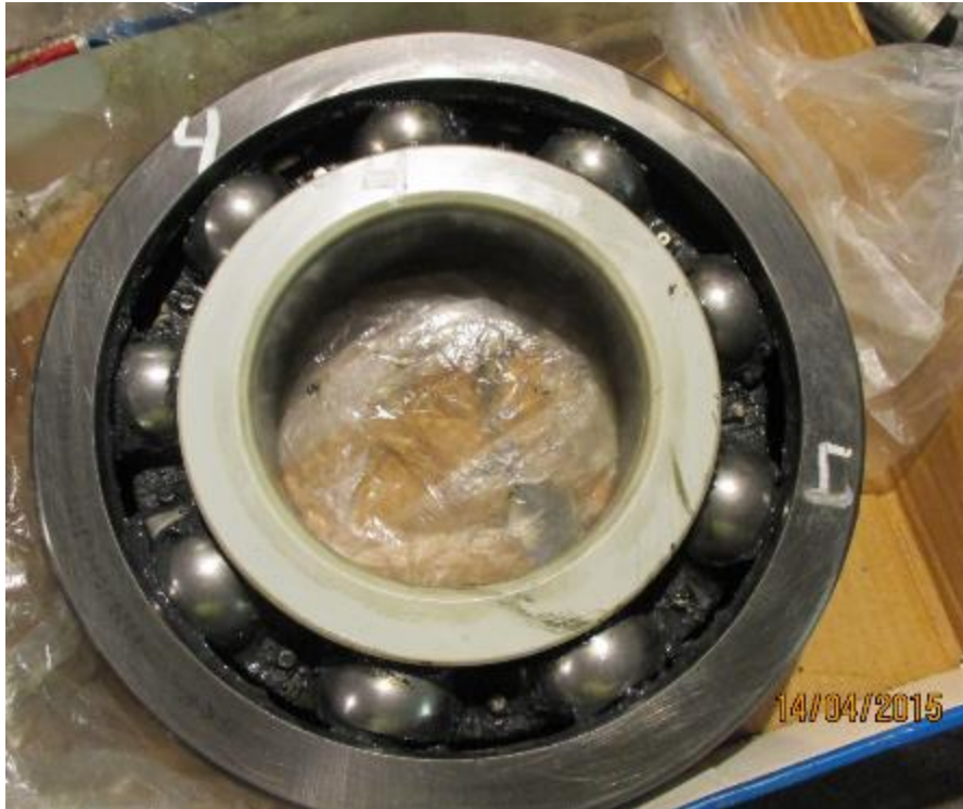
Kuva 28. WT4-laakeri 6330/ C3 VL 2071 joka on sisäkehältään eristetty.
