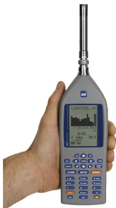
Kuva 77. Melunmittaukseen soveltuva äänitasomittari (Norsonic Nor131) [Kuvan lähde: MIP Electronics Oy, www.mip.fi ].
