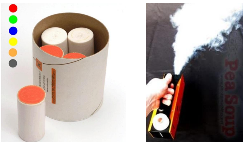
Kuva 41. Esimerkkejä ilmanvaihtojärjestelmän tutkimiseen soveltuvista merkkisavuista. Vasemmalla on värjätty savupatruuna ja oikealla savukone. [Kuvan lähde: Pietiko Oy, https://www.pietiko.fi/ .]
