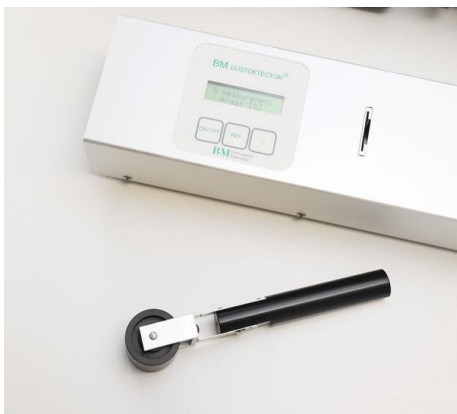
Kuva 75. Optinen pintapölymittari (BM Dustdetector) sekä geeliteippien painamiseen tarkoitettu tela. [Kuvan lähde: Poistoa Oy, https://homesiivous.fi .]
