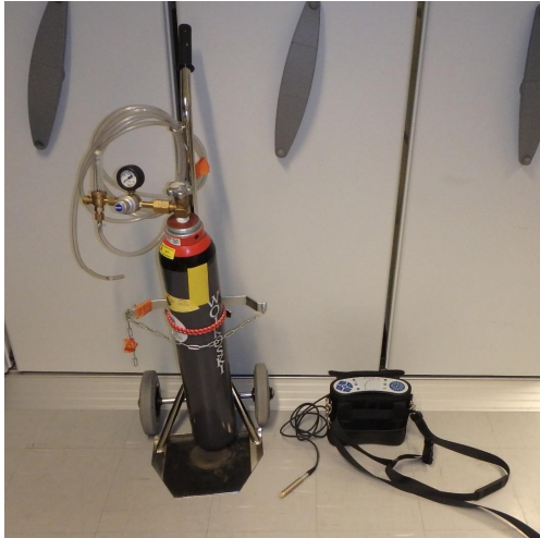
Kuva 40. Tyypillinen merkkiainelaitteisto. Vasemmalla on typpi-vety-seosta sisältävä merkkiainekaasupullo ja oikealla kyseiseen merkkiaineeseen reagoiva analysaattori kantolaukussaan. [Kuvan lähde: IdeaStructura Oy.]
