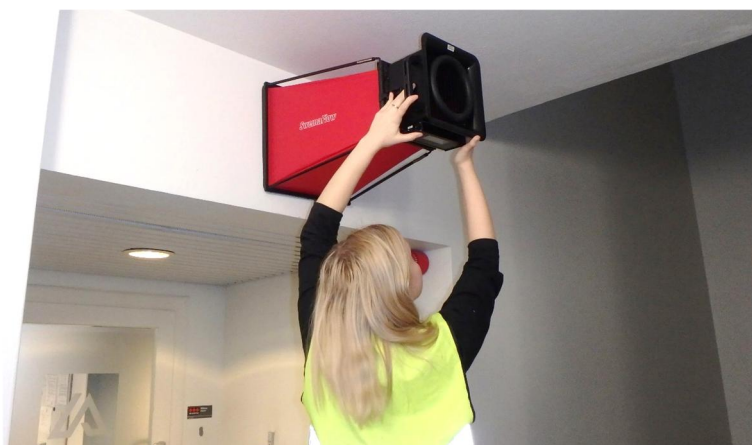
Kuva 65. Ilmavirran mittaus pääte-elimestä balometrillä. [Kuvan lähde: IdeaStructura Oy.]
