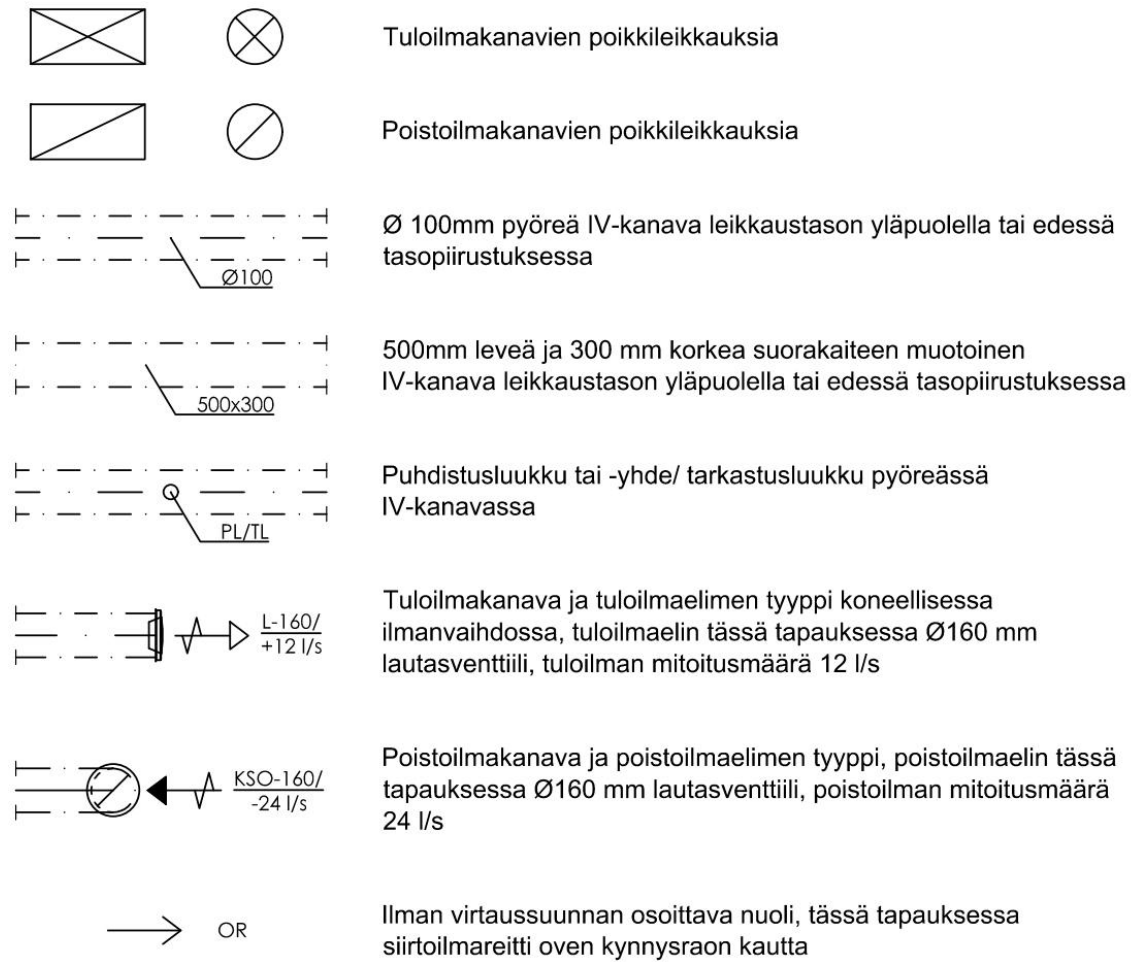
Kuva 25. Yleisiä IV-suunnitelmissä käytettyjä kanavien ja ilmavirtojen merkintätapoja.
