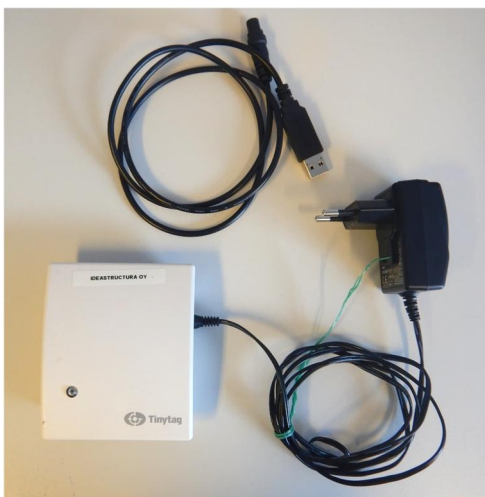
Kuva 72. Sisäilman hiilidioksidipitoisuuden seurantaan soveltuva loggeri Tinytag TGE-0010. Loggeriin kuuluu mittausyksikön lisäksi virtajohto sekä datakaapeli, jolla mittausdata saadaan siirrettyä tietokoneelle. [Kuvan lähde: IdeaStructura Oy.]
