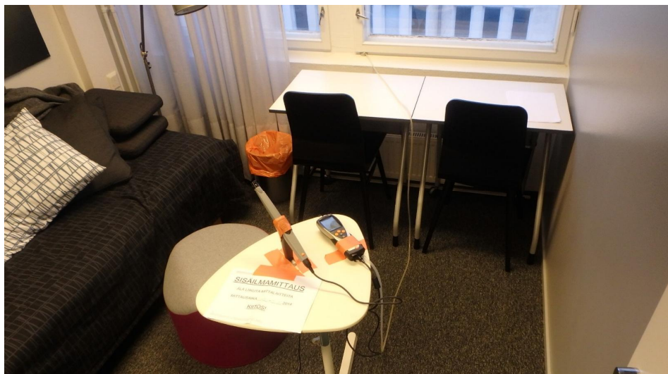
Kuva 74. Sisäilman olosuhteiden mittaus Testo 435-4-mittalaitteella. Laite mittaa samanaikaisesti sisäilman lämpötilaa, suhteellista kosteutta, hiilidioksidipitoisuutta sekä sisä- ja ulkoilman välistä paine-eroa. [Kuvan lähde: IdeaStructura Oy.]
