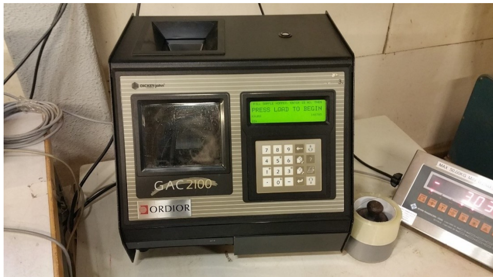
Kuva 50. Määrityksessä käytetty Dickey-John vilja-analysaattori.
