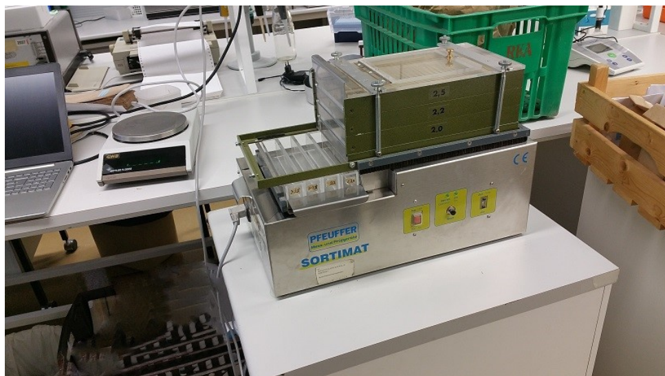
Kuva 58. Seulonnassa käytettiin apuna Pfeufferin Sortimat-seulontakonetta.
