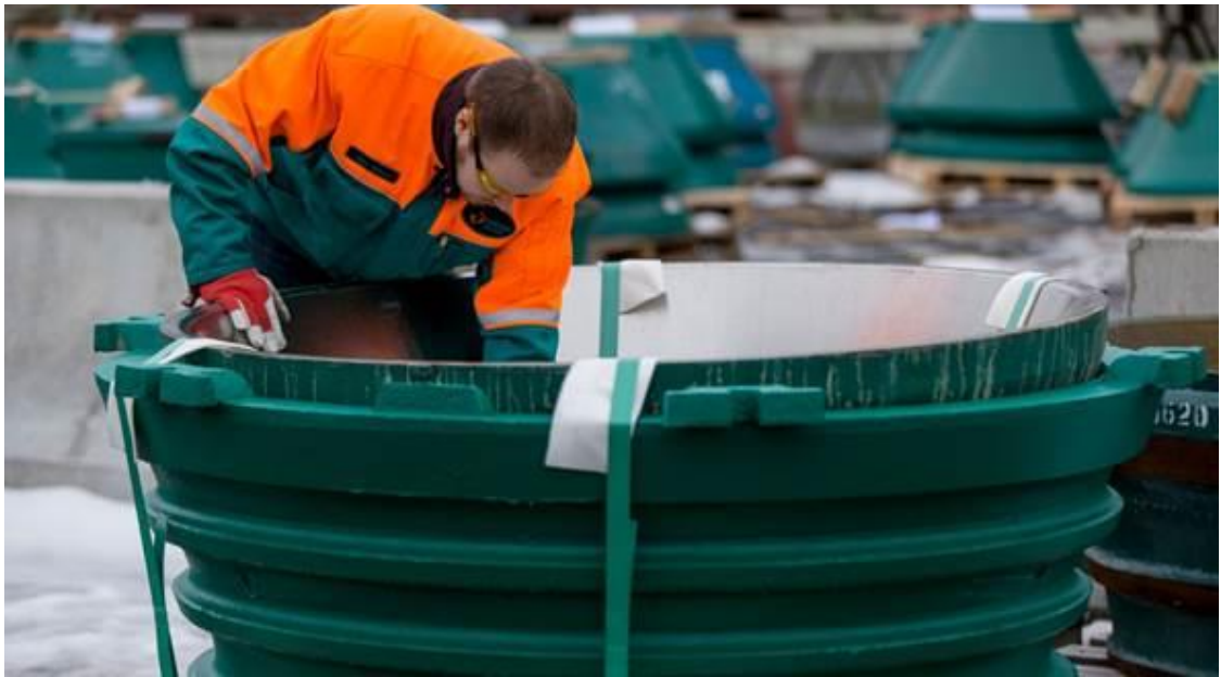
KUVA 5 Ulomman murskauskartion alaosan asento tuotannossa liikuteltaessa (Murskainten kulutusosat 2018)
