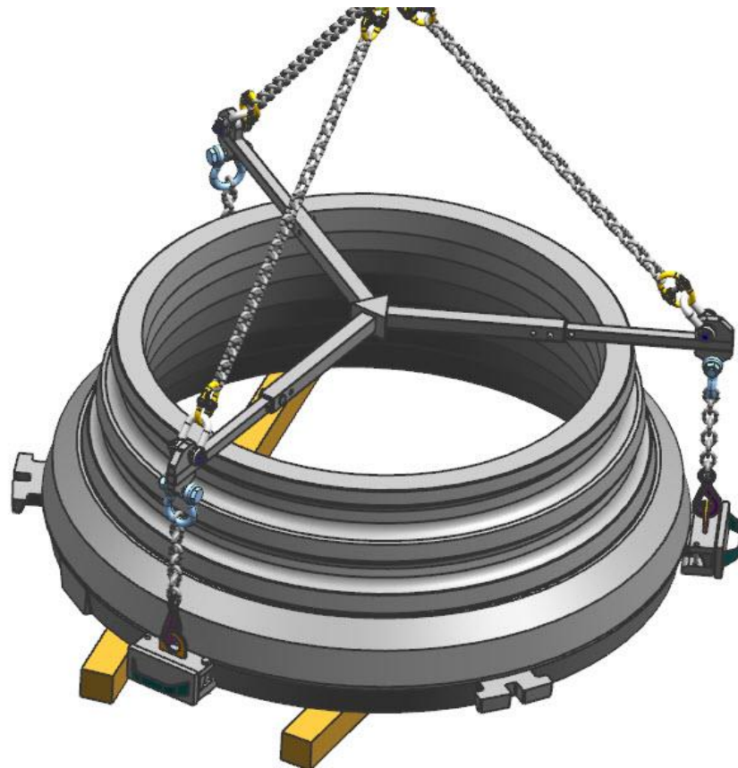
KUVA 26 Ketjut tuotu levittäjän avulla aluksi pystysuoraan ylöspäin
