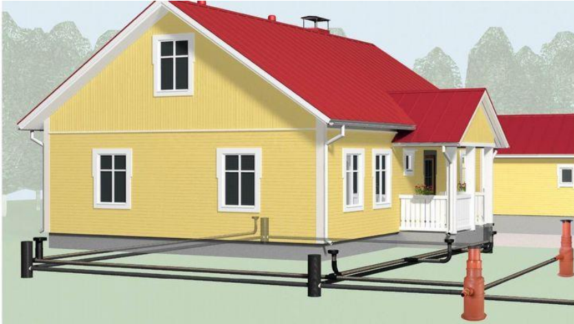
KUVA 2. Salaoitusjärjestelmä (4, linkit→ Perustus→ Salaoja- ja sadevesiputket)
