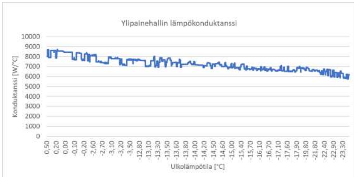
KUVA 22. Ylipainehallin lämpökonduktanssi ulkolämpötilan mukaan
