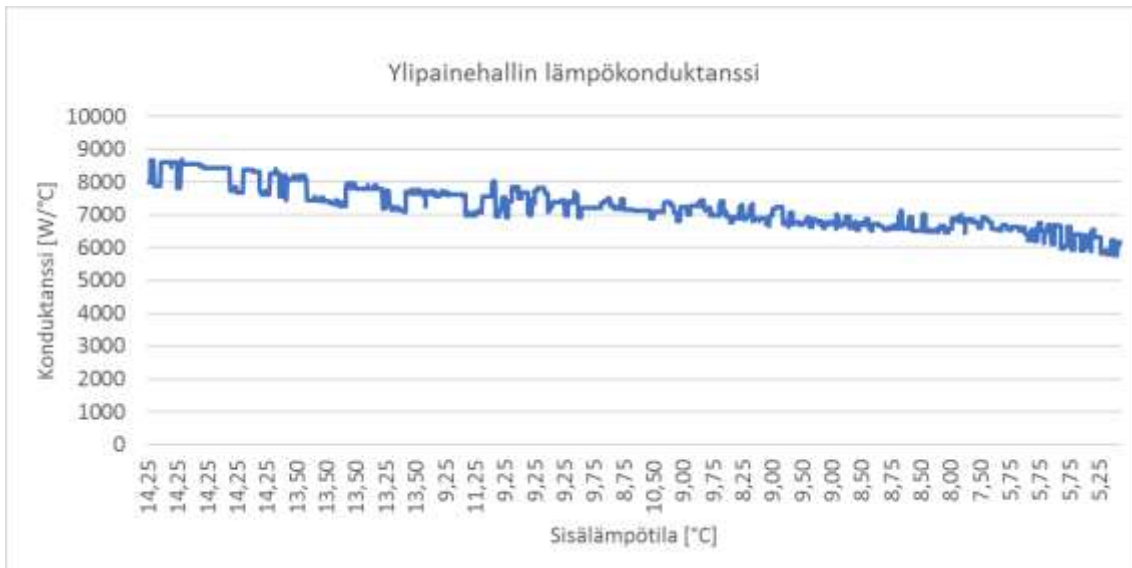
KUVA 23. Ylipainehallin lämpökonduktanssi ja sisälämpötila
