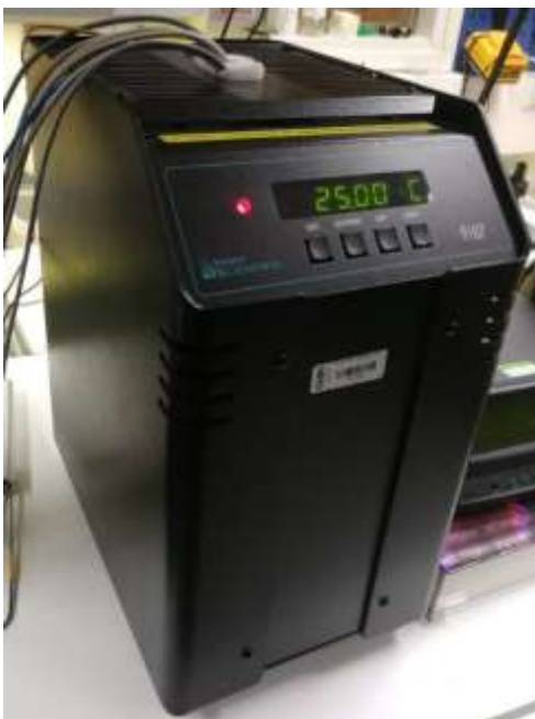
KUVA 7. Hart Scientific 9107 -kalibrointilaite
