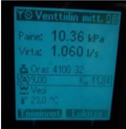
KUVA 8. Vesivirtaaman mittaustulos Oras 410032 -linjasäätöventtiilistä
