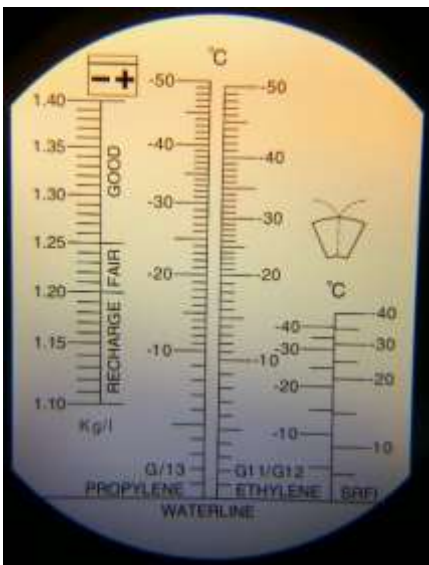
KUVA 29. Sosiaalitalan ilmanvaihtokoneen TK203 täyttösäiliön etyleeniglykolin pakkasenkestävyys
