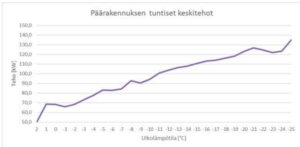
KUVA 30. Päärakennuksen kaukolämmön tuntiset keskitehot ulkolämpötilan mukaan
