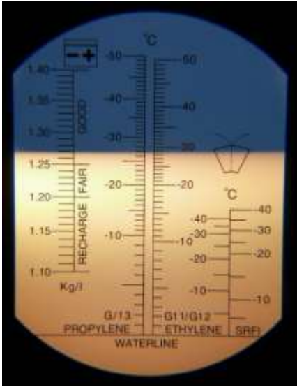
KUVA 28. Sosiaalitalan ilmanvaihtokoneen TK203 etyleeniglykolin pakkasenkestävyys
