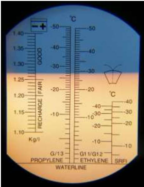
KUVA 19. Ylipainehallin etyleeniglykolin pakkaskestävyys
