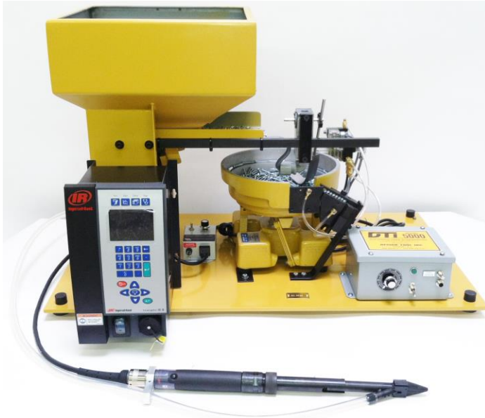
KUVA 5. Tärymaljaa ja pneumaattista syöttötapaa hyödyntävä väänninjärjestelmä (DTI 2018)
