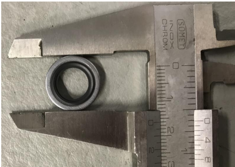
KUVA 4. Kierretulppaan yhdistettävä tiivisterengas (Kuva: Tommi Kaarenoja 2018)
