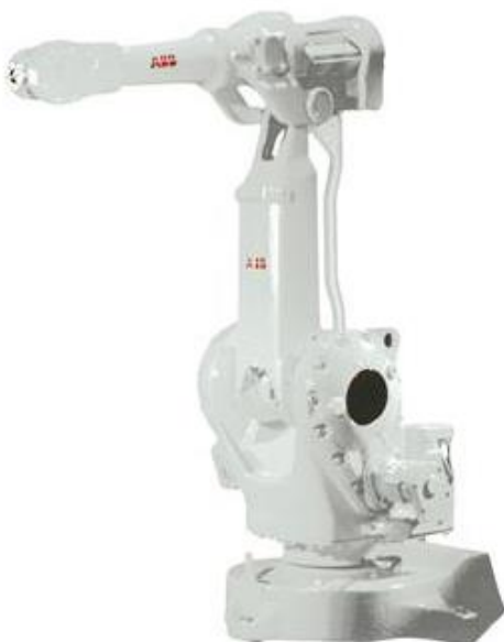
KUVIO 6. Kiertyvänivelisen robotin rakenne (ABB 2018)
