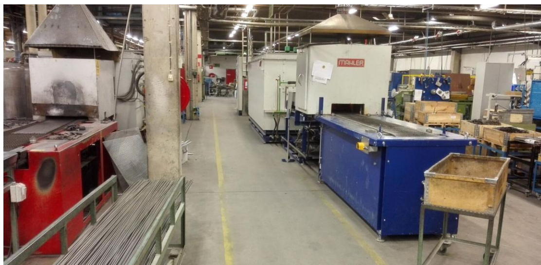
Kuva 7. Suoran elementin nauhauunit. Vasemmalla Elsiman tummahehkusuuuni, oikealla Mahlerin kirkashehkusuuuni.
