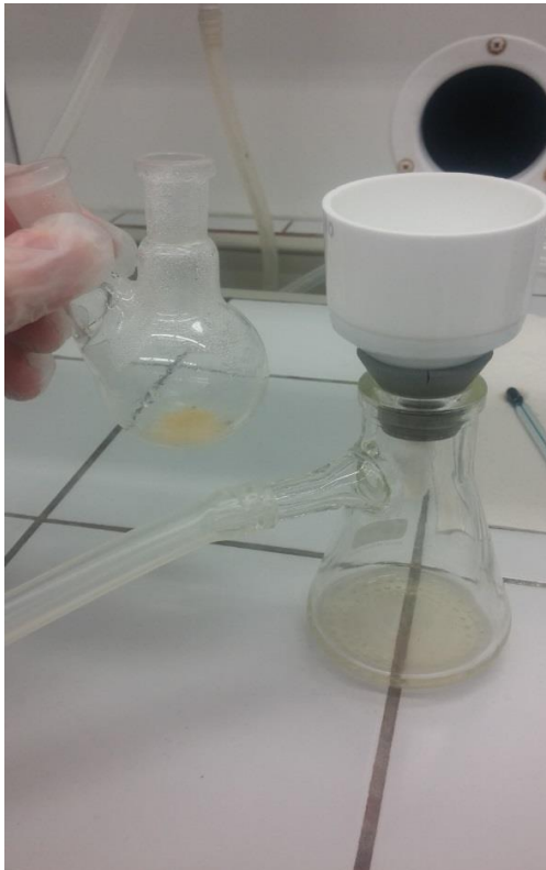
KUVA 8. Hydrolyysin jälkeinen näytteen suodatus
