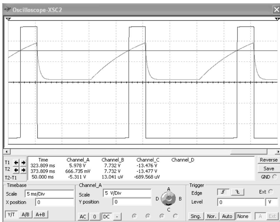
Kuva 6.4 Tyristorisuuntaajan ohjaus signaalin muodostuminen vertailijassa.
